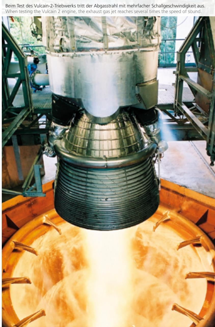
Beim Test des Vulcain-2-Triebwerks tritt der Abgasstrahl mit mehrfacher Schallgeschwindigkeit aus.
