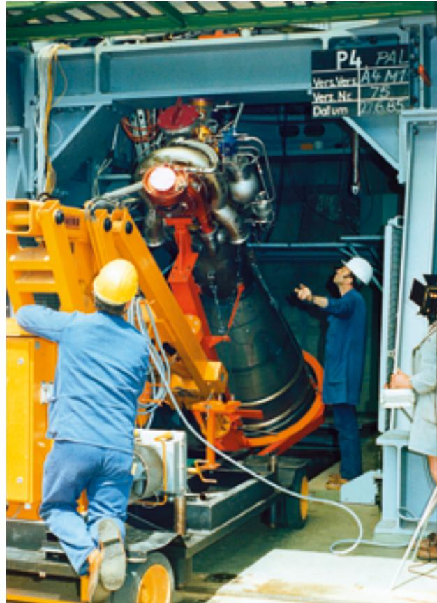
Einbau eines Viking-Triebwerks auf dem Prüfstand. Im Laufe des Ariane-Programms übernahmen DLR-Mitarbeiter immer mehr Verantwortung bei der Durchführung der Versuche. Installation of a Viking engine on the test facility. Within the course of the Ariane program DLR employees took on an increasing amount of responsibility for the conduction of tests.
