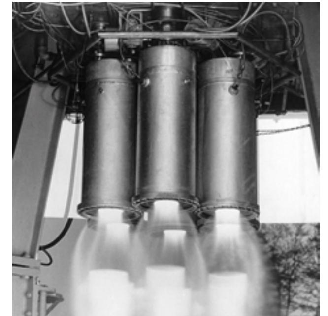
Versuchsaufbau des Sechserbündels der OTRAG-Rakete. Test setup of the six OTRAG rocket bundles.
