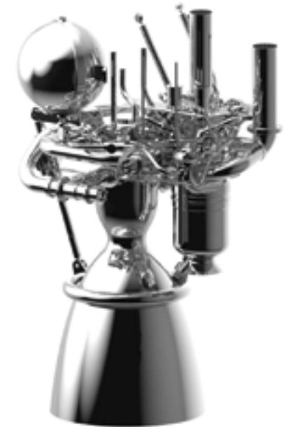
Im „Prometheus“-Projekt arbeiten CNES, ArianeGroup und das DLR gemeinsam an der Entwicklung eines kostengünstigen, schubstarken und wiederverwendbaren Raketentriebwerks, das mit Flüssigsauerstoff und Flüssigmethan angetrieben werden soll.
