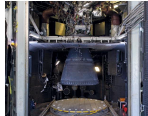
DLR-Ingenieure testen seit 2016 das neue wiederzündbare Vinci-Triebwerk für die Oberstufe der Ariane 6 unter Höhenbedingungen im DLR Lampoldshausen.
