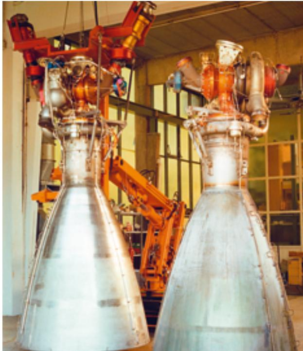
Für die Ariane-Rakete kam das Viking-Triebwerk zum Einsatz. Am P4.2 wurde es unter Höhenbedingungen in Lampoldshausen getestet. Viking, the engine for the Ariane, was tested on P4.2 under vacuum conditions in Lampoldshausen.
