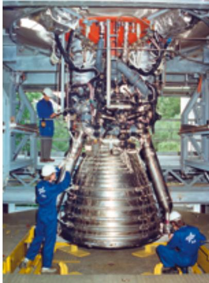
Einbau eines Vulcain-Triebwerks am Prüfstand P5.
