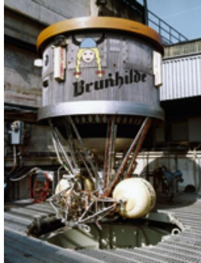
Die 3. Stufe der Europa-Rakete, von den DLR-Technikern „Brunhilde“ getauft, wurde am Prüfstand P3 in Lampoldshausen getestet. The 3rd stage of the Europa rocket, christened „Brunhilde“ by DLR technicians, was tested at the test facility P3 in Lampoldshausen.
