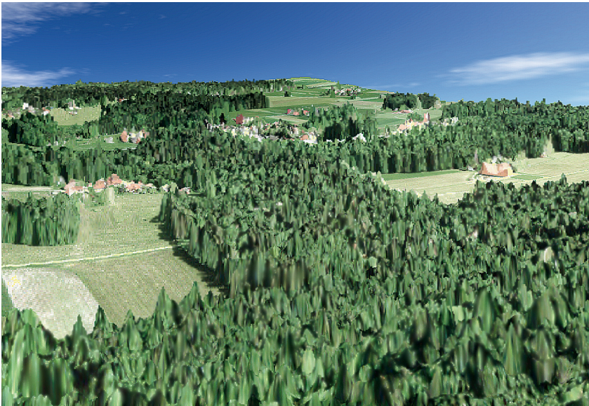
3D-Darstellung des Stadtwaldes von Traunstein. Die Waldhöhen wurden aus Radardaten mit Hilfe der polarimetrischen SAR-Interferometrie gewonnen.
