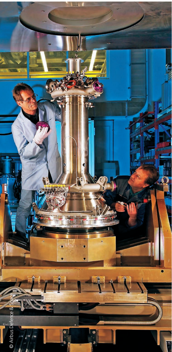
Ingenieure in Ottobrunn arbeiten an einem neuen Brennkammer-Typ, der die Nutzlastkapazität der Ariane 5-Oberstufe in Zukunft verbessern wird. Ottobrunn engineers are working on a new type of thrust chamber, which will enhance the capabilities of the Ariane 5 upper stage.
