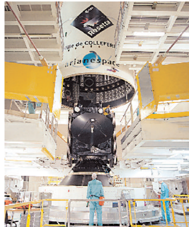
Integration des Rosetta-Satelliten in Ariane 5 (ESA/CNES/ARIANESPACE/Service Optique Guayane)
