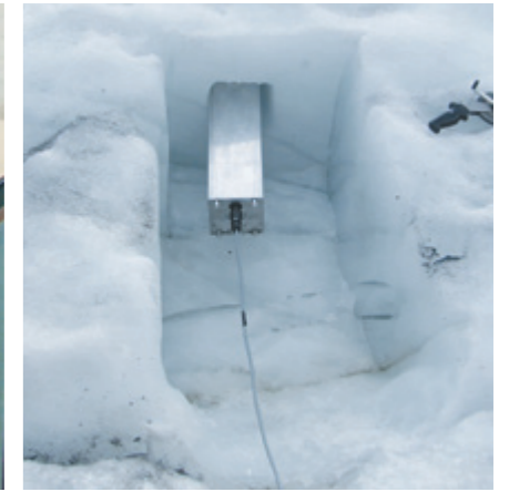
In der rund 1,2 Meter langen Eisbohrsonde ist viel Technik auf engstem Raum untergebracht: Ultraschall, ein Empfangssensor für Pinger-Signale, eine kleine Inertial Measurement Units (IMU), zwölf Heizpatronen im Schmelzkopf und eine Kabelspule stecken in dem IceMole.
