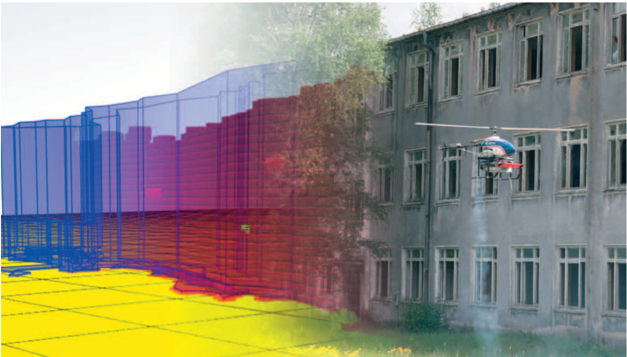
Während der Befliegung unbekannter Orte entsteht eine Umgebungskarte, die genutzt wird, um Kollisionen zu vermeiden und Flugwege zu planen
