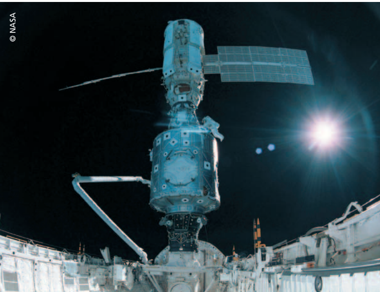
Im Dezember 1998 begann die Crew der Mission STS-88 mit der Konstruktion der Internationalen Raumstation ISS. Das Foto zeigt das Andocken des US-amerikanischen Moduls Unity an das russische Modul Sarja. Mit an Bord: Sergey Krikalev.
