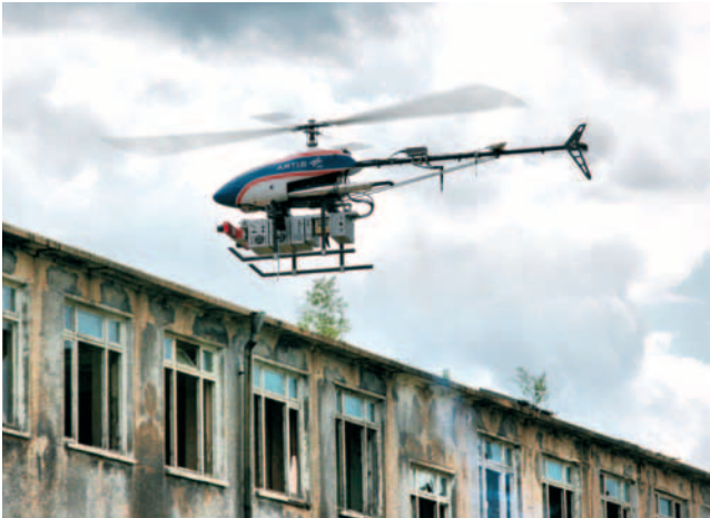
Mittels einer Stereokamera werden unbekannte Hindernisse selbstständig von ARTIS erkundet und vermessen
