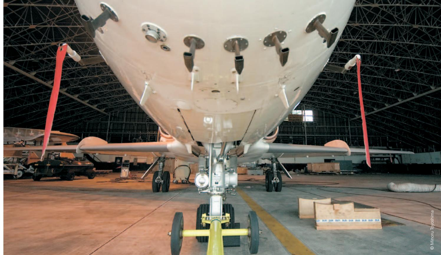
Am Bug hat das Messflugzeug beheizbare Einlässe, über die im Flug die Umgebungsluft zu den Sensoren für Temperatur und Feuchte geleitet wird
