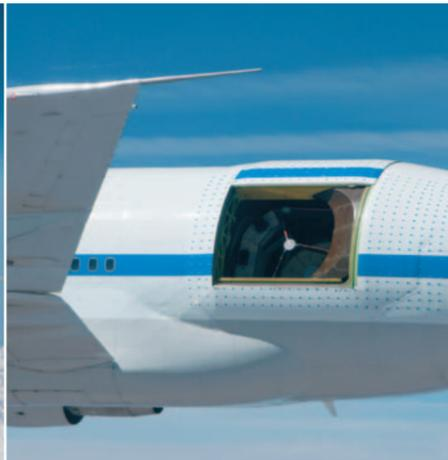
Erstmals öffnet sich die Teleskoptür des Stratosphären-Observatoriums, das künftig in jedem Jahr bei circa 100 Nachtflügen Infrarotstrahlung aus dem All aufnehmen wird
