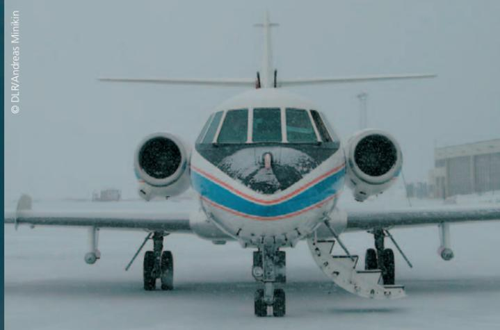
Hier fliegt kein gewöhnliches Flugzeug: Nasenmast, Einlässe an der Flugzeugaußenhaut für diverse Messinstrumente und Sensoren unterhalb der Tragflächen machen die Falcon einzigartig
