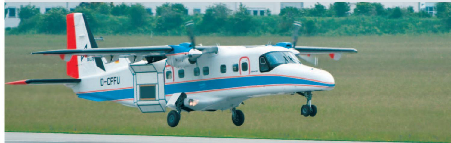
Das DLR-Forschungsflugzeug Do 228 im Einsatz für die Klimaforschung: Es gewinnt Radar-Daten zur Bodenfeuchtebestimmung
