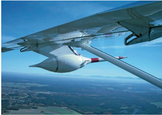
Mit der Atmosphärenforschungssonde MetPod, die an einem Unterflächenträger der Cessna angebracht ist, können Messungen zur Physik der Atmosphäre durchgeführt werden. Dank eigens dafür modifizierter Sensorik lassen sich Druck, Temperatur, Feuchte, Windrichtung und -geschwindigkeit mit einem Instrument erfassen.
