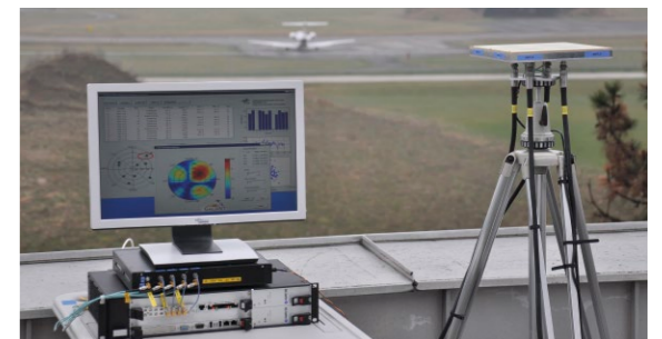
Versuche zeigten, dass sich Störsignale mit der GALANT-Technologie unterdrücken lassen
