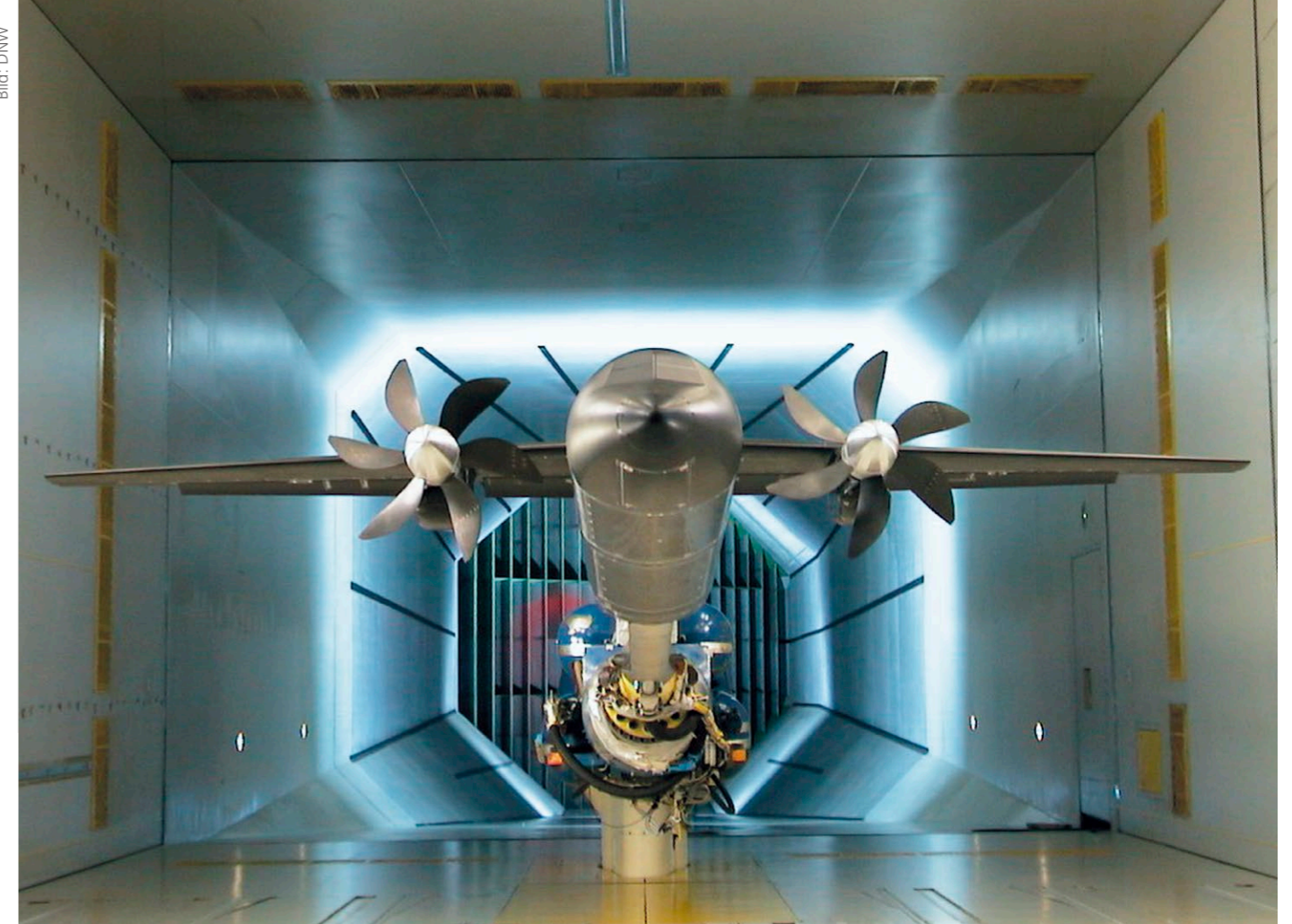
2014 wurden im DNW-LLF die Propeller des APIAN-Modells (Advanced Propulsion Integration Aerodynamics and Noise) vermessen
