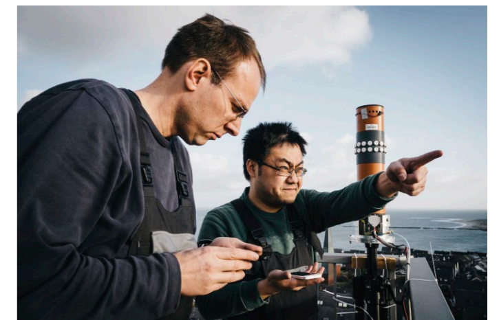
Ausrichtung und Position der Antenne müssen exakt bestimmt werden, um die gewonnenen Daten im heimischen Labor analysieren zu können
