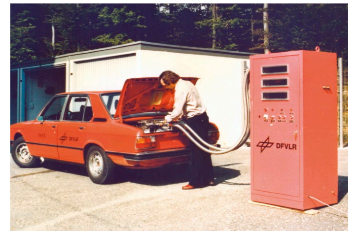
1978: Das DLR rüstet den ersten PKW in Europa für den Betrieb mit Flüssigwasserstoff um
