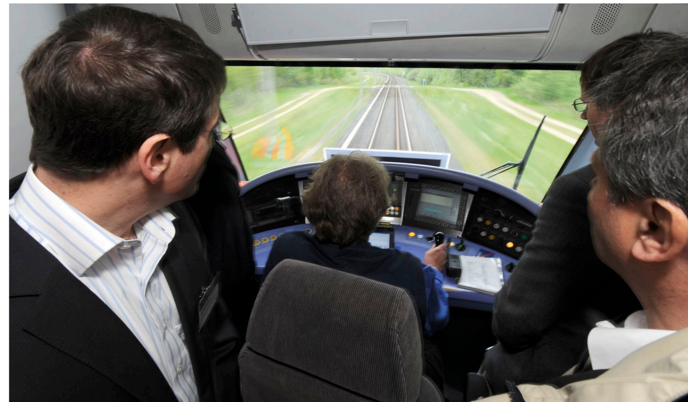
Erste Fahrt mit einem Antikollisionssystem für Züge. Die öffentliche Demonstration des Railway Collision Avoidance System, kurz RCAS, in einem realen Zug auf einer Teststrecke der Bayerischen Oberlandbahn im Jahr 2010 verlief erfolgreich. Inzwischen wird das im DLR konzipierte System industriell umgesetzt.
