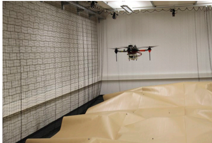
Dieser autonom agierende Multikopter ist Teil eines Schwarms. Jeder kartiert mit Hilfe eines Ultraschallsensors selbstständig die Umgebung. Im Versuch werden Bodenprofile mit einer Plane simuliert. Die einzelnen Messungen werden an die anderen Schwarmmitglieder kommuniziert, sodass ein Gesamtbild der Umgebung entsteht.
