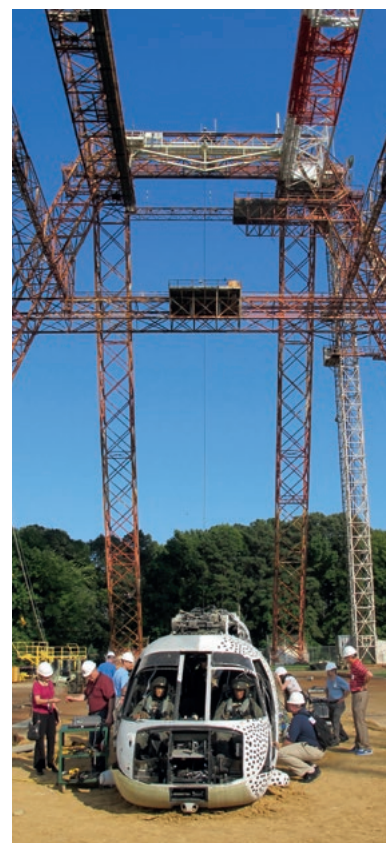
Nach dem Aufprall untersuchen die Wissenschaftler den Hubschrauber-Rumpf. Rechts: Sequenz aus dem Crashtest TRACT2.
