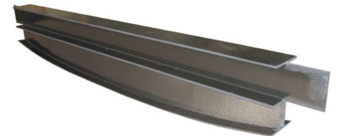
Struktur aus Faserverbundkunststoff: Sie wurde anstelle des Metallbodens in den Unterboden der Hubschrauberzelle (oben im Bild) eingebaut
