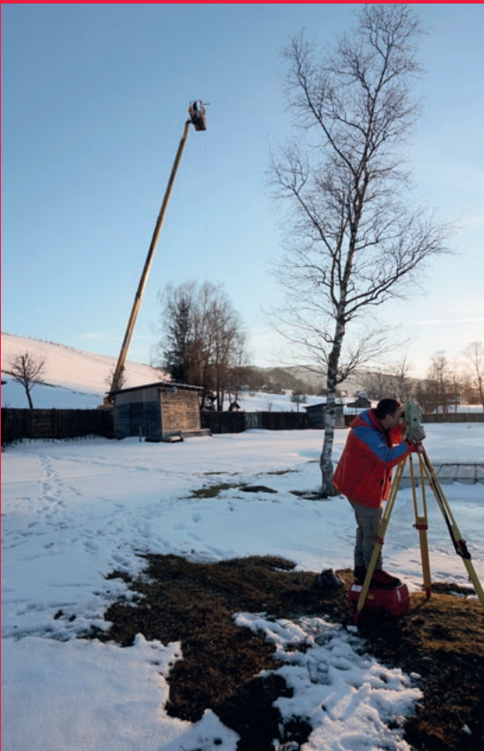
Um die Bodenreflexionen eines Funksignals zu messen, das von einem Flugzeug oder einem Satelliten ausgestrahlt wird, installierten die Wissenschaftler für Versuche 2014 und 2015 den Channel Sounder auf einem 40 Meter hohen Kran
