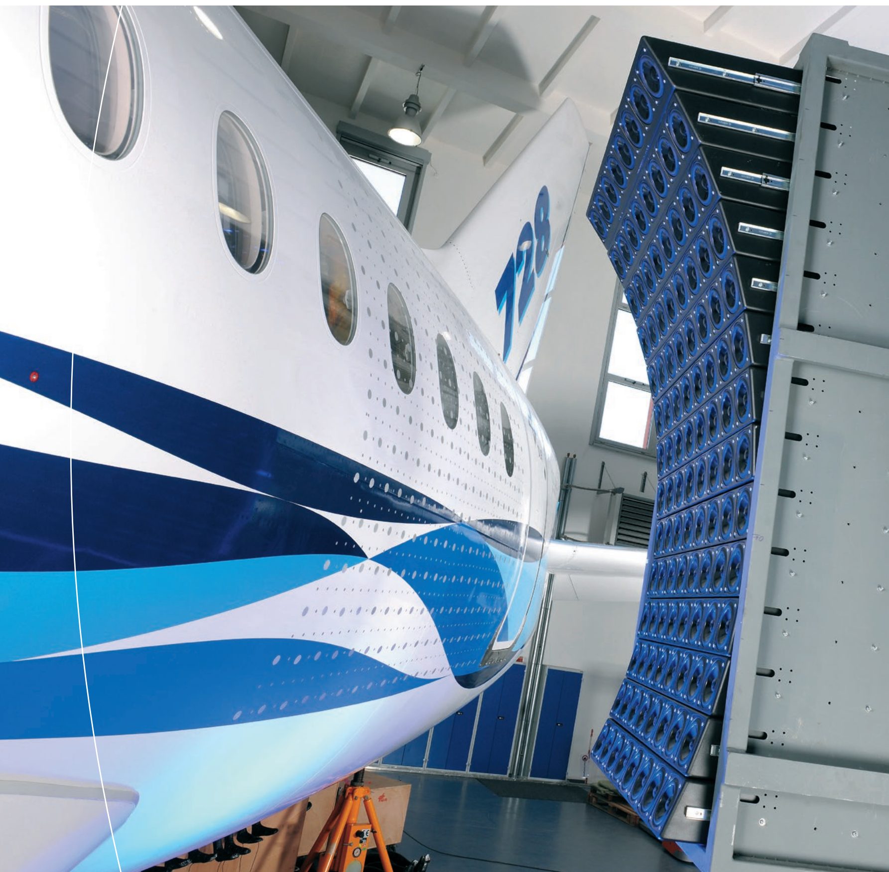
Ein Lautsprecher-Array, bestehend aus 112 einzelnen Schallquellen, simuliert das komplexe Schallfeld eines CROR-Triebwerks. Als Testobjekt dient das DLR-Versuchsflugzeug Dornier Do 728. Es wurde zum Versuchslabor für Kabinenakustik und Klimatisierung umgebaut.
