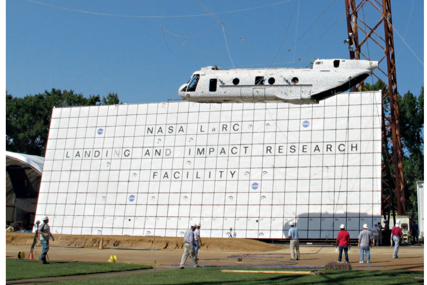
Hochgeschwindigkeitskameras ermöglichen es, jeden einzelnen der über 8.000 schwarzen Punkte auf der Außenhaut des Hubschraubers zu verfolgen und genau zu sehen, wie sich der Rumpf unter der Crashbelastung verformt
