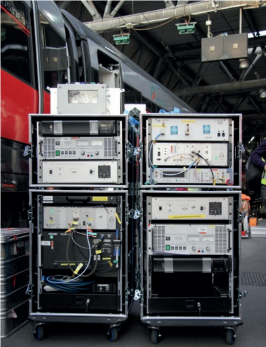
Der Channel Sounder besteht aus einer Sende- und einer Empfangseinheit. Der Empfänger zeigt, wie das Funksignal durch die Umgebung reflektiert wird.
