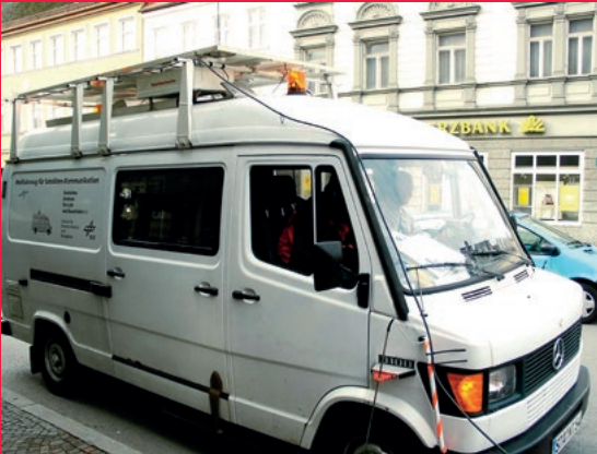
Im Jahr 2002 untersuchten DLR-Wissenschaftler mit dem Channel Sounder den Funkkanal zwischen einem Messbus und einem Zeppelin
