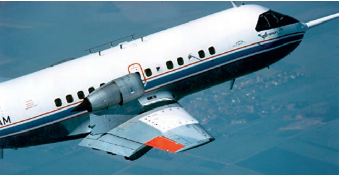
Flugversuch mit Laminarhandschuh am ATTAS
