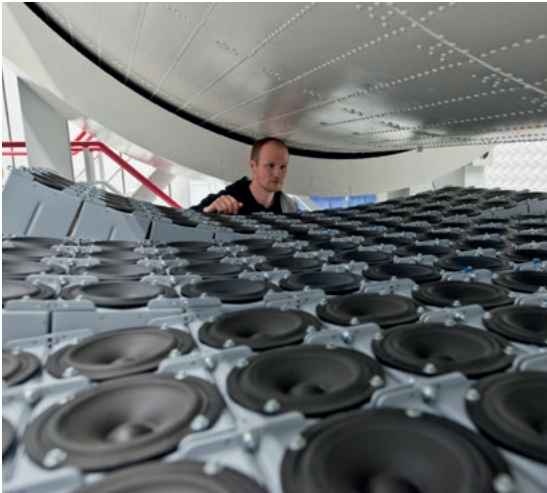
Das Lautsprecher-Array zum Beschallen des Demonstrators. Es hat 132 Elemente und lässt sich an fast jede Stelle der Oberfläche fahren.
