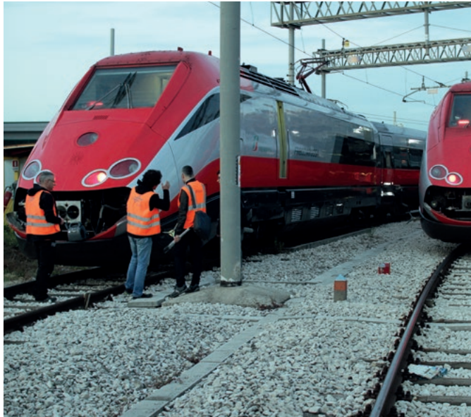
Die beiden Frecciarossa-Hochgeschwindigkeitszüge erreichen eine Höchstgeschwindigkeit von 360 Kilometern pro Stunde und haben eine Länge von 328 Metern. In ihren Spitzen installierten die Wissenschaftler Messantennen und Abstandsradar, um die Distanz der zwei Züge genau zu ermitteln und Informationen zwischen den Zügen auszutauschen.
