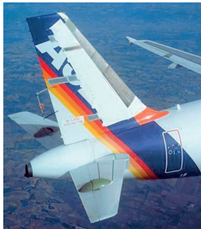
Das Absaugsystem am beziehungsweise im Leitwerk des A320. Von außen ließ es kaum auf den komplexen Aufbau im Inneren schließen.
