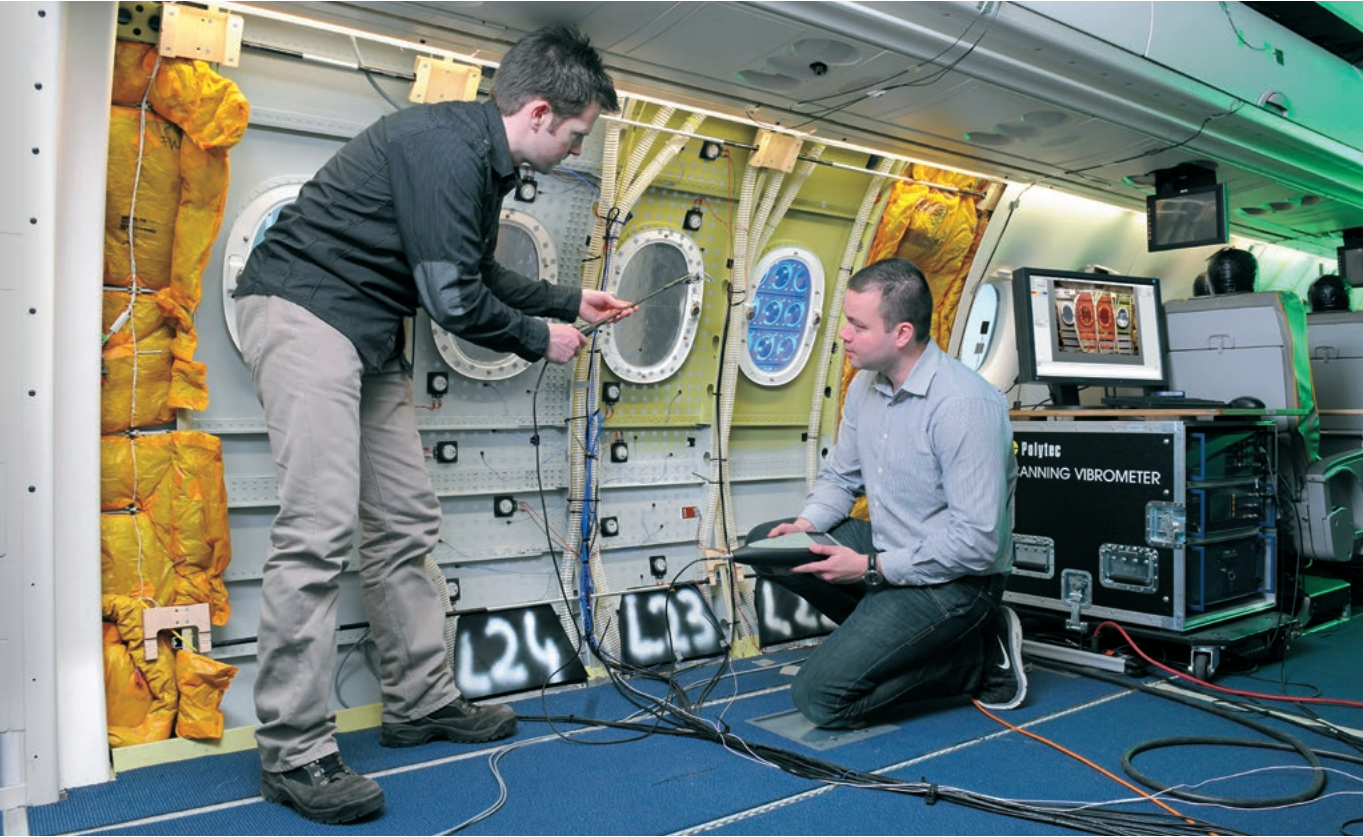
Mit einer Schallintensitätsmesssonde bestimmen Dr. Stephan Algermissen (links) und Dr. Oliver Unruh (rechts) die Geräusche direkt an der Schallquelle
