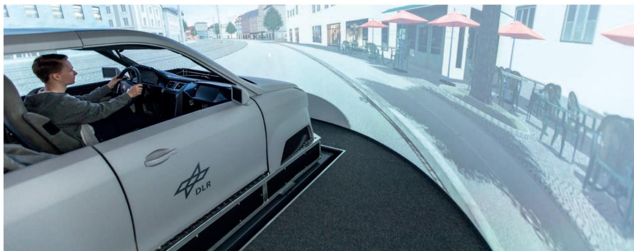
In einem sogenannten modularen Mock-up testet der Proband ein neues Fahrerassistenzsystem und hat dabei vollen Rundumblick
