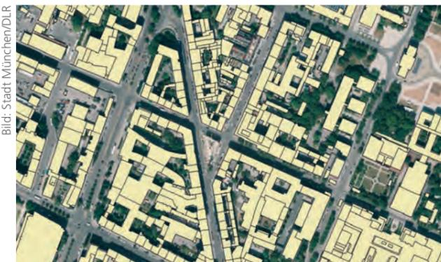
Mit Hilfe der Katasterdaten können die Hausumrisse aus den Luftbildaufnahmen herausgefiltert werden. Dachflächen werden so eindeutig erkennbar.
