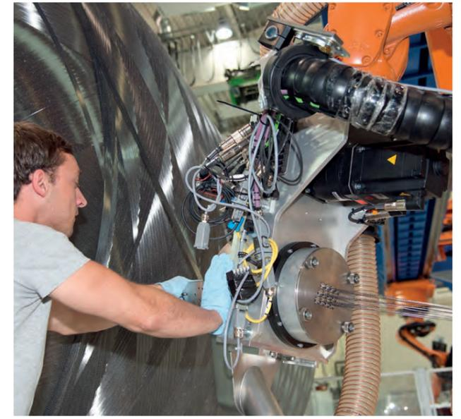
Ein Roboter wickelt die trockenen Fasern auf den Druckkörper. In der Entwicklungsphase prüft noch der Mensch den ordnungsgemäßen Ablauf des Prozesses.
