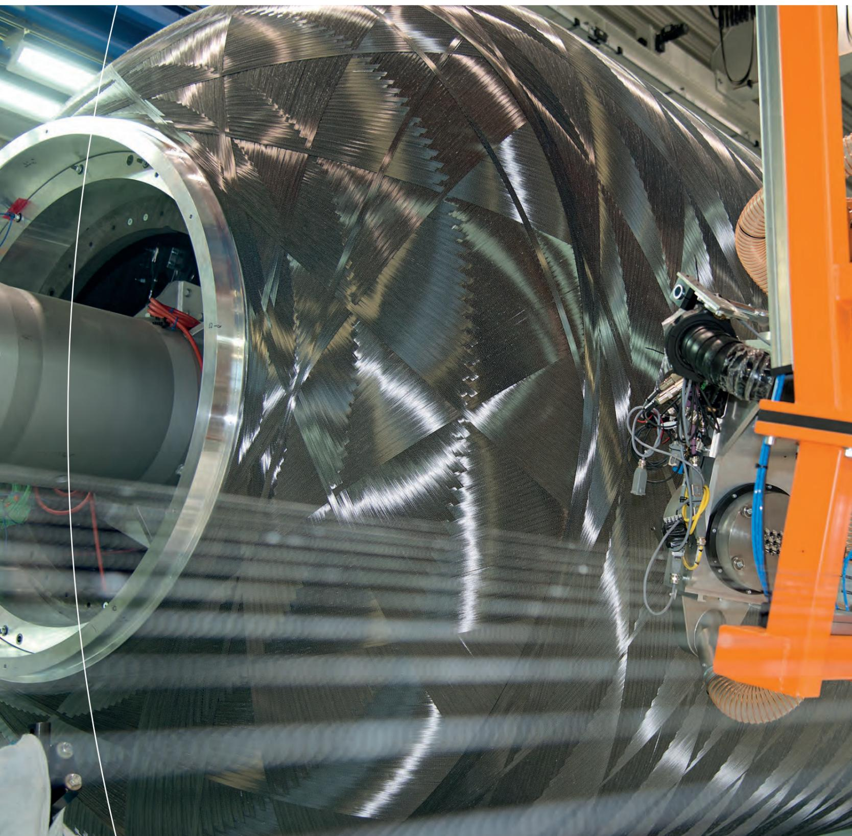
Die einzigartige Anlage im Zentrum für Leichtbauproduktionstechnologie (ZLP) in Augsburg verbindet zwei Produktionsprozesse miteinander: Bei der Produktion des Raketenboosters aus CFK können sowohl Faserbündel (Rovings) auf den Kern gewickelt (im Bild) als auch breitere Tapes abgelegt werden.
