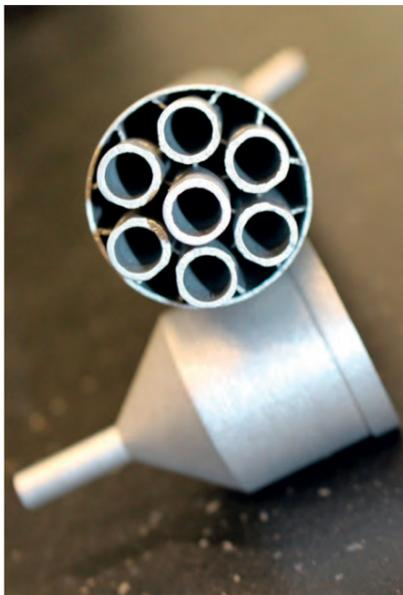
Die Röhren im Inneren des Kaltstartmoduls enthalten das Metallhydrid. Drumherum fließt das Wärmeträgerfluid.
