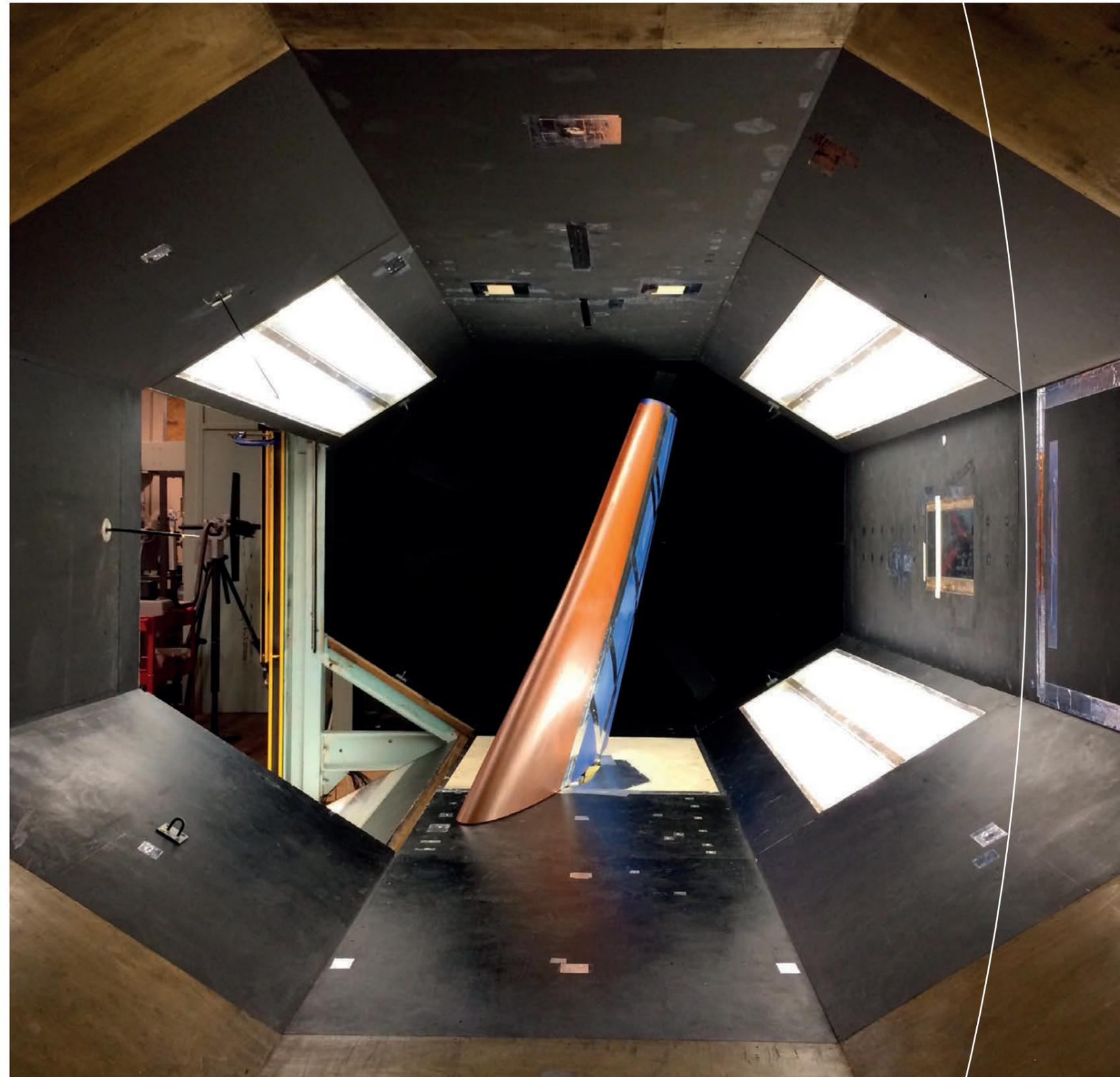
Systemtest eines Winglets mit formvariabler Flügelvorderkante im Windkanal der Universität Bristol: Ein bionischer, superelastischer Mechanismus im Inneren des Winglets ermöglicht eine Verformung um zwei Grad. Das soll den Luftwiderstand reduzieren und das Flugverhalten des Flugzeugs verbessern.
