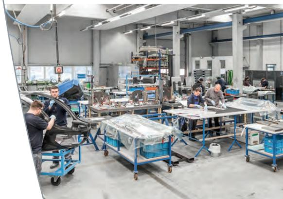
Blick in eine der Fertigungshallen: Zu den diversen Projekten, an denen hier gearbeitet wird, gehört auch eine Hubschrauberkabine in Faserverbundbauweise.
