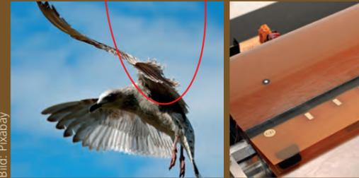
Landende Vögel verhindern durch das Aufstellen ihrer Deckfedern den Strömungsabriss am Flügel. Eine davon inspirierte Rückstromklappe am Rotorblatt eines Hubschraubers reduziert nach diesem Vorbild die Belastungen für dessen Steuersystem.
