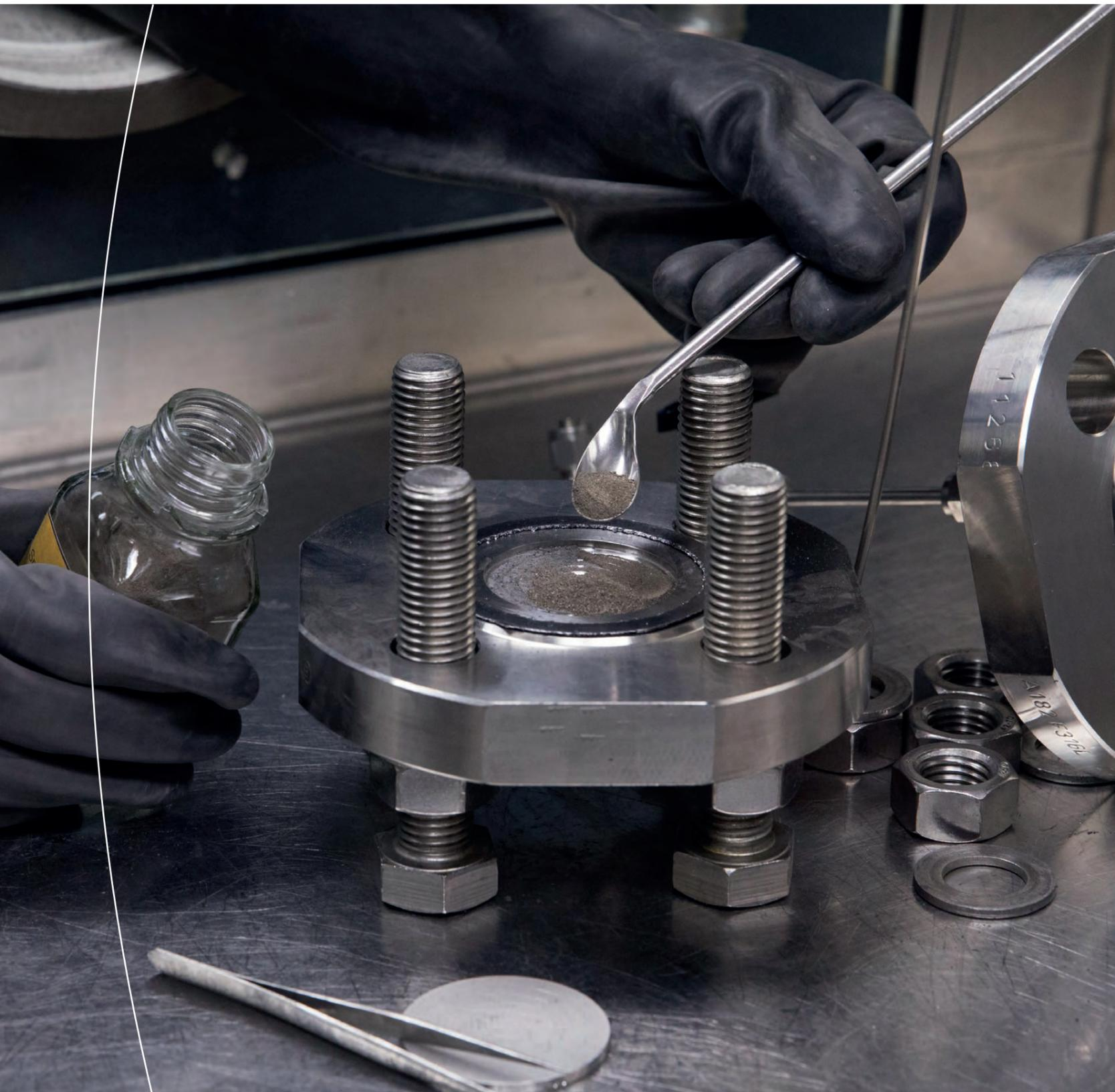
Das Metallhydridpulver wird in einen Versuchsaufbau gefüllt. Dazu arbeiten die Wissenschaftler in einer sogenannten Glovebox, die Sauerstoff ausschließt.
