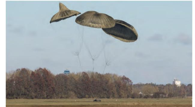
Drei Hauptschirme sorgen dafür, dass die tonnenschwere Last sanft zu Boden schwebt und unbeschadet landet
