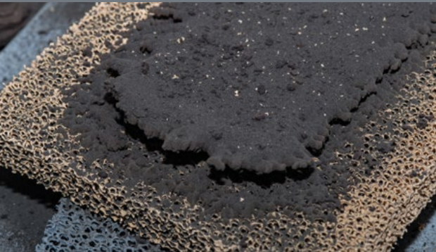
Der Ziegelstein entsteht auf einer Keramikunterlage, damit er in Form bleibt
