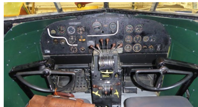
Cockpit des kleinen Verkehrsflugzeugs Lockheed Electra 12-26 von 1942: Interessant der weiß markierte Instrumentenbereich für den künstlichen Horizont, den Höhenmesser, die Geschwindigkeitsanzeige, den Kompass und den Wendezeiger.
