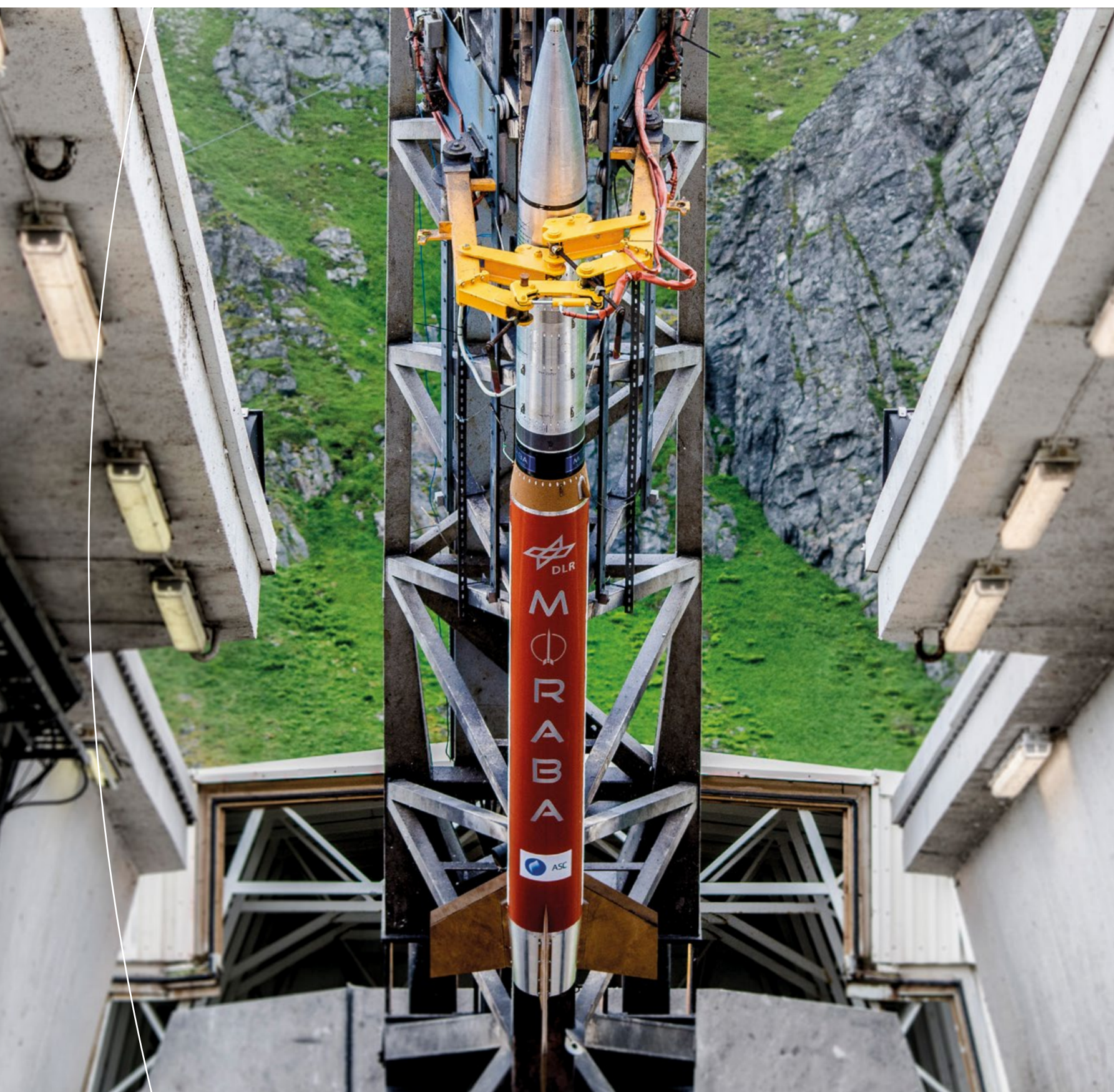
Die „Improved Malemute“, die Höhenforschungsrakete der MORABA, auf der Startrampe des Andøya Space Center in Norwegen. Unten im Bild zu sehen: Die im DLR Stuttgart entwickelten und gefertigten Finnen.
