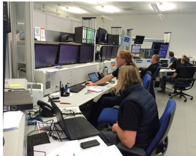
In der Steuerzentrale neben der Testzelle beobachten Wissenschaftler, Ingenieure und Techniker ganz genau Emissionen und Stabilität des Verbrennungsprozesses
