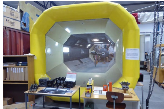
Windkanal der Königlich Technischen Hochschule: Hier wurden schon in den Dreißigerjahren Messungen bei einer Windschwindigkeit von bis zu 40 Metern pro Sekunde durchgeführt.
