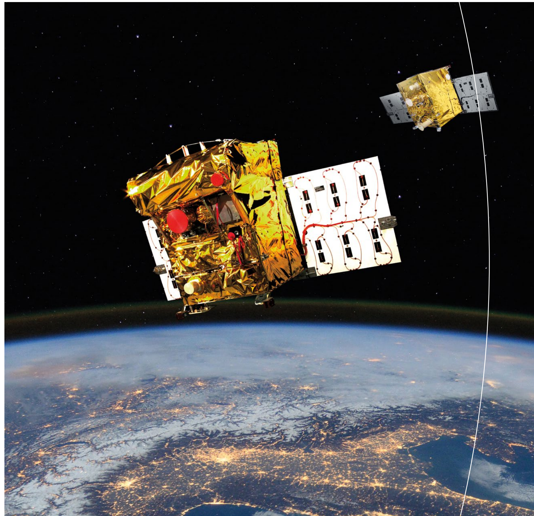
Die beiden Satelliten TET-1 und BIROS bilden zusammen die Mission FireBIRD (Fire Bispectral InfraRed Detector) – eine Mission zur Feuerfernerkundung. Neben Waldbränden sollen auch vulkanische Aktivitäten, Gasfackeln oder Industrie-Hotspots beobachtet und dokumentiert werden.
