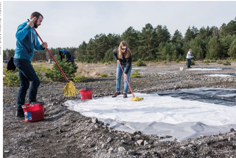
Bild: DLR/Moritz Küster Planen bilden die Krater nach. Damit die Kamera die Kontraste fehlerfrei erkennen kann, müssen sie sauber sein.
