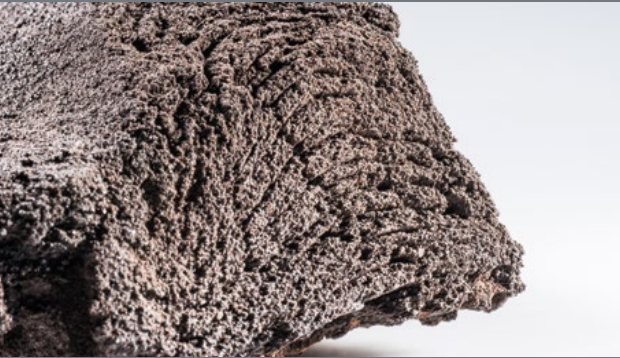
Noch weist der Ziegel eine Lamellenstruktur auf – im nächsten Schritt sollen sich die Schichten enger miteinander verbinden
