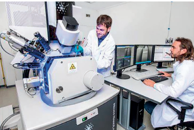
Philipp Watermeyer (links) und Mario Eggeler an der Zweistrahl-Ionenfeinstrahl-Anlage. Mit der Anlage können Materialproben mit dem Ionenstrahl sehr dünn geschnitten werden. Von jeder Schnittoberfläche wird mit der Elektronenoptik eine Aufnahme gemacht. Aus den einzelnen Aufnahmen werden mit einem Computer digitale dreidimensionale Bilder berechnet.
