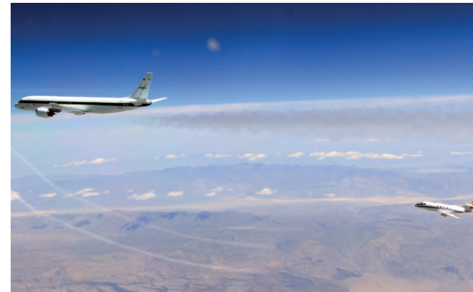
Umweltschonend fliegen: Dass Beimischungen von Biotreibstoff die Emission von Rußpartikeln gegenüber der Verbrennung von reinem Kerosin um mehr als die Hälfte reduzieren können, zeigen Forschungsflüge des DLR und der NASA. Hinter einer DC-8 messen Wissenschaftler an Bord der DLR-Falcon die Abgaszusammensetzung.
