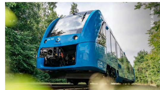
Im Regionalverkehr unterwegs: Die wasserstoffbetriebene Regionalbahn ist regelmäßig im Norden Niedersachsens zwischen Cuxhaven und Buxtehude im Einsatz – geräuscharm und emissionsfrei
