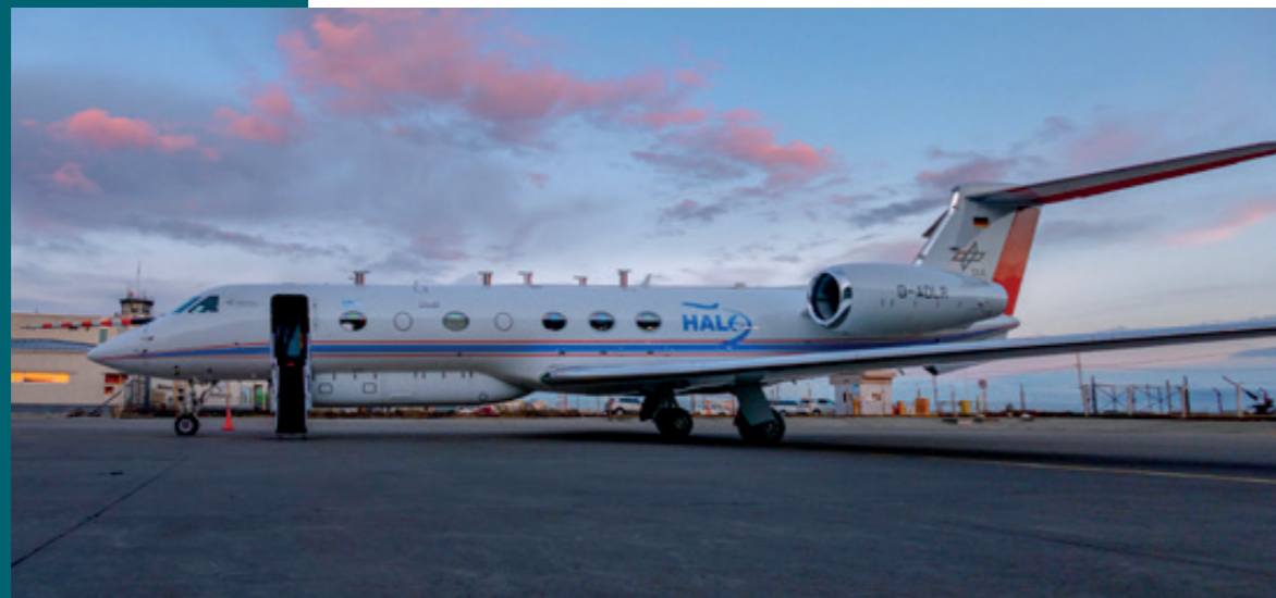
Das Forschungsflugzeug HALO auf dem Vorfeld des Flughafens in Río Grande. Am oberen Rand des Rumpfes sind die Einlässe zu erkennen, mit denen die Luft ins Kabineninnere angesaugt und dort auf ihre Zusammensetzung hin analysiert wird.
