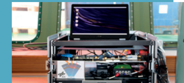
Der Szintillationsrekorder des DLR-Teams, das Herzstück der Messanlage an Bord der Polarstern
