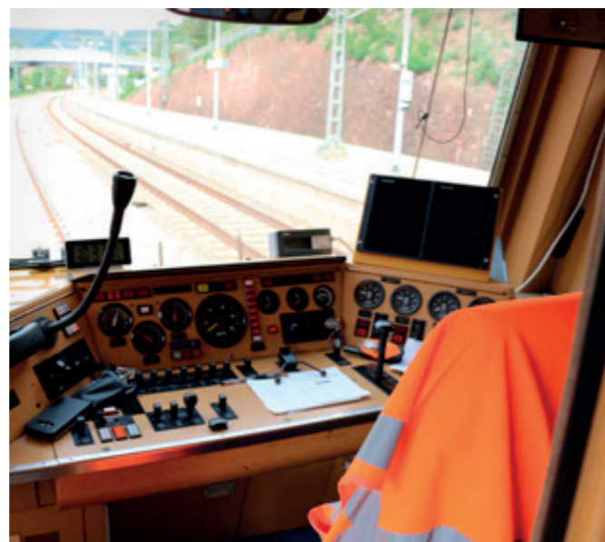
„Fahrerloses“ Zugcockpit bei der Testfahrt im sächsischen Erzgebirge
