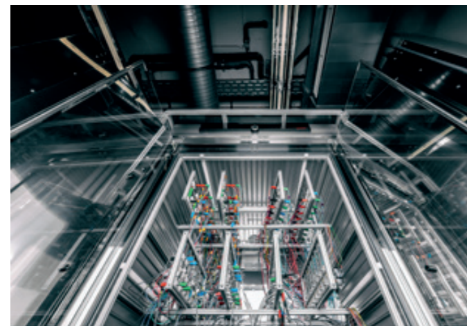
Blick in die Klimakammer des DLR-Instituts für Technische Thermodynamik in Stuttgart. Hier werden Batterien unterschiedlichster Art getestet, um die Vorgänge im Innern genauer zu verstehen und die Batterien kontinuierlich zu verbessern.
