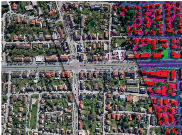
Künstliche Intelligenz wird eingesetzt, um Luft- und Satellitenbilder zu klassifizieren. So erkennt der Algorithmus Verkehrswege, Fahrzeuge und unterschiedliche Fahrbahnmarkierungen auf dieser Aufnahme einer Szene von München aus etwa 500 Kilometer Entfernung. © EOC
