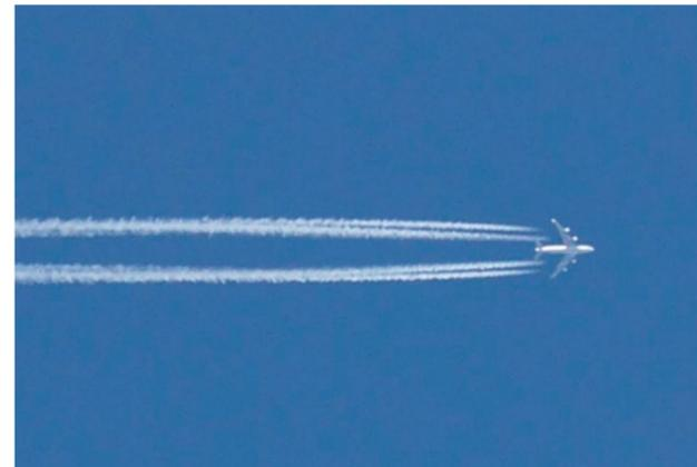
Flugzeugtriebwerke stoßen Rußpartikel aus. An ihnen kondensieren kleine unterkühlte Wassertropfen und gefrieren sofort zu Eis. Sie werden als Kondensstreifen am Himmel sichtbar.
