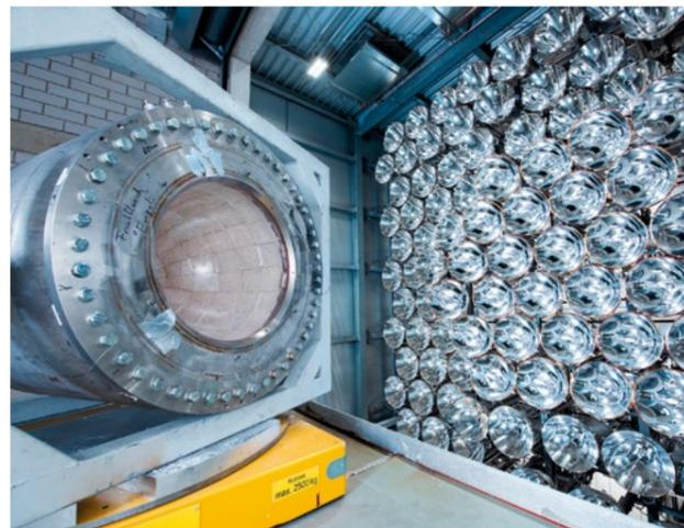
Dieser Reaktor nutzt die Energie von Sonnenstrahlung, um Wasserstoff zu erzeugen. Er steht im Hochleistungsstrahler Synlight des DLR Jülich.
