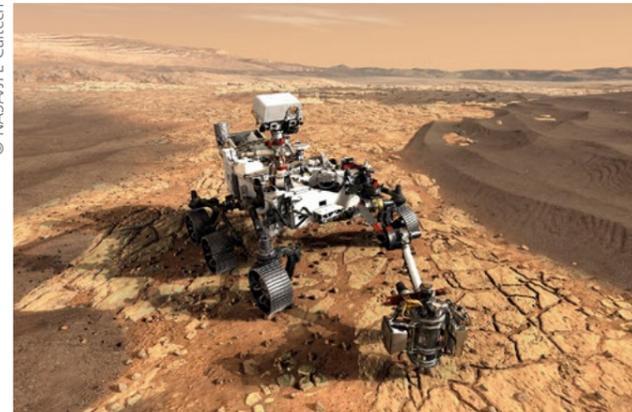
Der Rover Perseverance der Mars-2020-Mission nimmt mit seinem Arm Proben des Marsgesteins und legt diese versiegelt auf dem Boden ab
