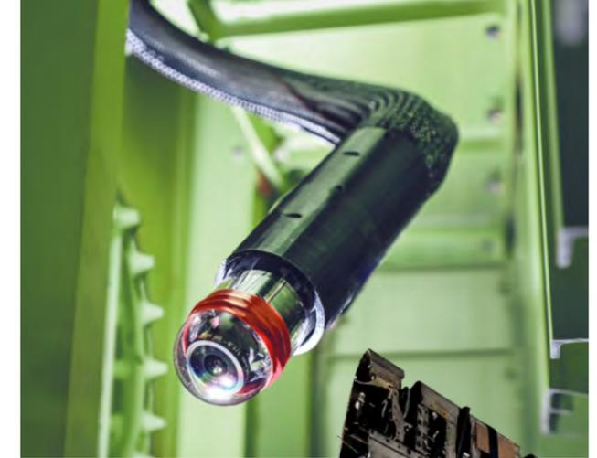
Ein Tauchroboter schlängelt sich durch Treibstofftanks im Flügel. Das macht die Inspektion für Servicemitarbeitende sicherer und effizienter.
