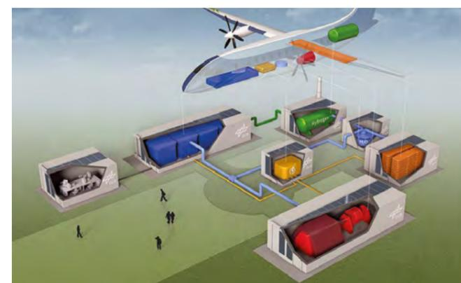
Schematische Darstellung des BALIS-Testfelds, auf dem Brennstoffzellen für die Luftfahrt entwickelt werden sollen
