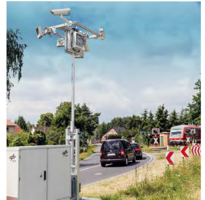
Untersuchung des Verkehrsverhaltens an einem Bahnübergang in Braunschweig. Die Ergebnisse zeigten, dass in durchschnittlich jeder sechsten Rotphase ein Verkehrsteilnehmer die Schienen illegal überquerte.
