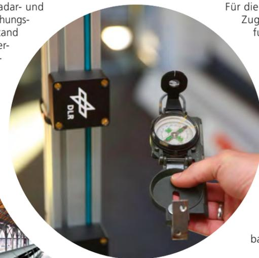
Leitungen, Brücken, Kabel, Stahlbetonmauern) ist viel Metall verbaut. Dieses beeinflusst das Magnetfeld, stört beispielsweise auch einen Magnetkompass. Die Störungen sind von Ort zu Ort unterschiedlich. „Genau das nutzen wir, um Informationen über Position, Gleis und Geschwindigkeit zu erhalten. Diese Methode funktioniert auch sehr gut in Tunneln“, ergänzt Dr. Andreas Lehner vom DLR-Institut für Kommunikation und Navigation.
