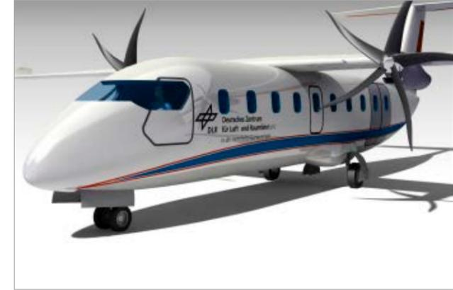
Visualisierung des Demonstrationsflugzeugs Dornier 328 mit Wasserstoff-Brennstoffzelle
