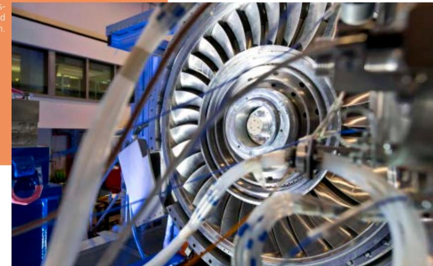
Grob vereinfacht nutzen Turbinen die Energie eines komprimierten, heißen Gasgemischs, um Rotorschaufeln anzutreiben. Im Kraftwerk wird diese Bewegungsenergie mithilfe eines Generators in Strom umgewandelt. Im Flugzeug nutzt man sie letztlich für den Vortrieb.
