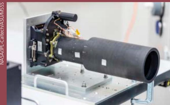
Psyches hochauflösende Multispektralkameras bestehen aus zwei identischen Kameras zur Erfassung von Geologie, Topographie und Mineralogie.
