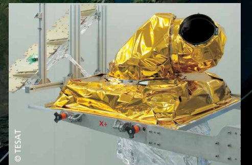
Auf dem Weg zur Datenautobahn: Ein modifiziertes LCT wird auf Alphasat eine Datenmenge von 130 DVDs pro Stunde über eine Distanz von 45.000 Kilometer transportieren. Damit wird die Übertragung zwischen Satelliten im Low Earth Orbit und denen im Geostationären Orbit möglich. Mit dieser Technologiedemonstration made in Germany stößt Alphasat I-XL das Tor zum europäischen Datenrelaisystem EDRS auf.
