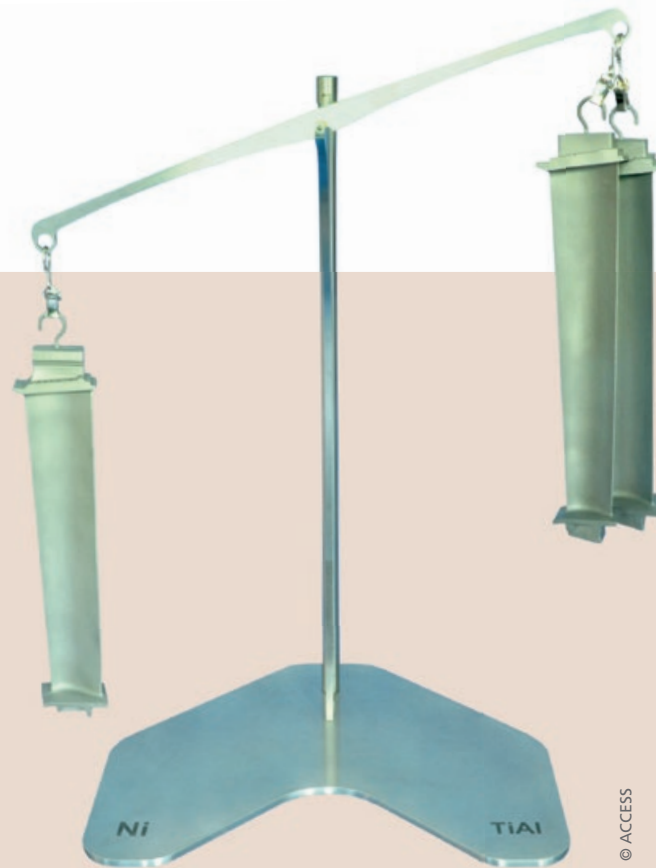
Auf der ISS wird auch Forschung betrieben, die Turbinenschaufeln für Flugzeugtriebwerke leichter machen soll. Eine Schaufel auf Titan-Aluminium-Basis ist zum Beispiel nur halb so schwer wie eine gewöhnliche Nickel-basierte Schaufel.
