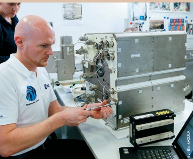
Der deutsche ESA-Astronaut Alexander Gerst trainiert in Köln, wie die EML-Anlage einzubauen und zu bedienen ist. Er wird den Elektromagnetischen Levitator auf der ISS in Empfang und in Betrieb nehmen.
