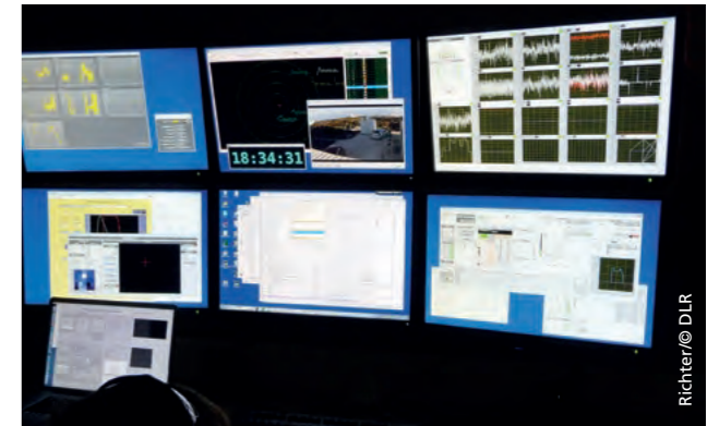
Kontrollzentrum im Container: In der mobilen T-AOGS-Bodenstation treffen die Daten von Alphasat I-XL ein. Die Experimentdaten können direkt vor Ort überprüft werden.
