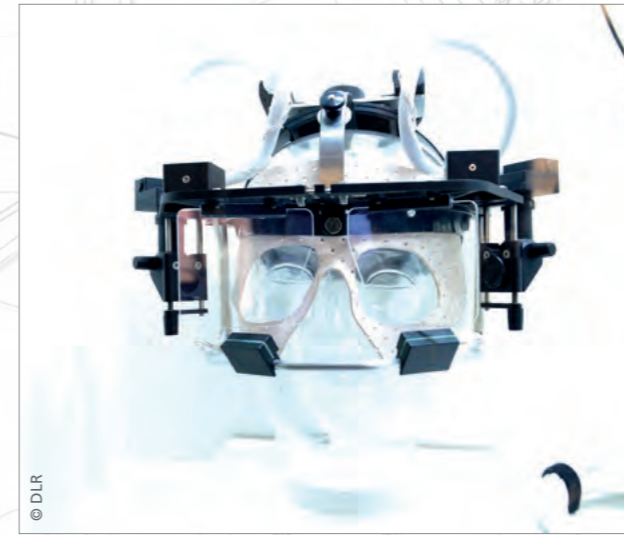
Mit dem Eye-Tracking Device wurden die Augenbewegungen der Astronauten auf der Internationalen Raumstation ISS verfolgt, um mehr über die sogenannte Raumkrankheit zu erfahren. Diese Technik wird auf der Erde mittlerweile bei Laseroperationen des Auges eingesetzt (links). Seit dem Start von TIROS, dem ersten Wettersatelliten überhaupt, im Jahr 1960, sind die Vorhersagen viel zuverlässiger geworden. Heute können die Experten zum Beispiel Niederschlag oder Temperaturen zu verschiedenen Tageszeiten über gut sieben bis zehn Tage hinweg vorhersagen (rechts).
