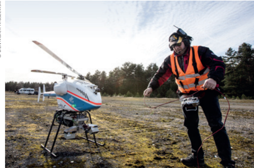
Mit dem unbemannten Hubschrauber superArtis erforscht das DLR Themen wie Flugzeug- und Umgebungserkennung, Flugbahnplanung und Flugsteuerung. Er wurde auch schon zur humanitären Hilfe oder bei Forschungsmissionen über dem Meer eingesetzt.
