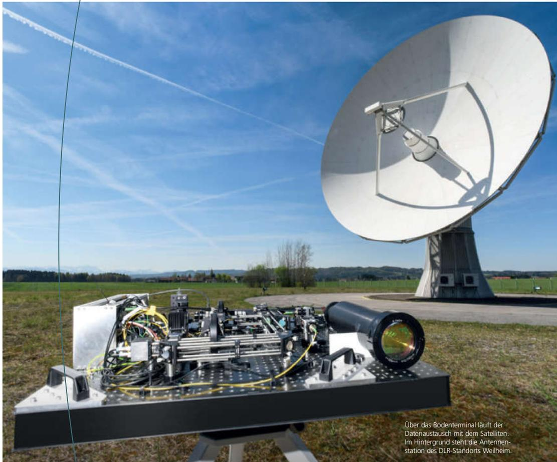
Über das Bodenterminal läuft der Datenaustausch mit dem Satelliten. Im Hintergrund steht die Antennenstation des DLR-Standorts Weilheim.
