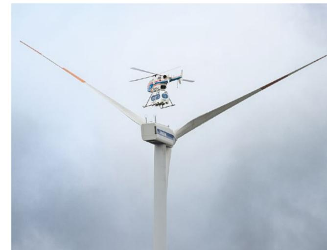
Mit dem unbemannten DLR-Hubschrauber superARTIS wurde im EnBW-Windpark Schwienau II unter anderem die Kommunikation zwischen Drohne, Windenergieanlage und Leitwarte erprobt.
