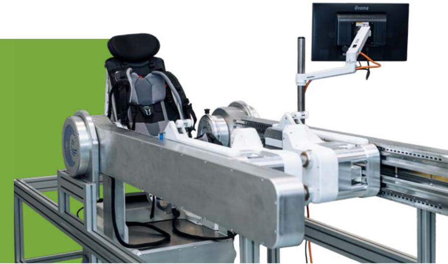
Der Prototyp von ATHLETIC (Astronaut Health EnhancementT Integrated Countermeasure) steht im DLR-Institut für Luft- und Raumfahrtmedizin. Das Gerät in Form eines Exoskeletts soll später ein hoch intensives Kraft- und Sprungtraining gegen eine passiv erzeugte Kraft in der Schwerelosigkeit ermöglichen.
