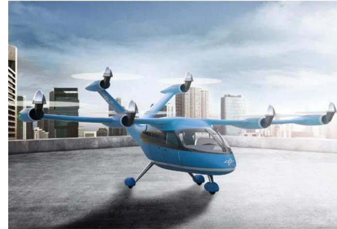
Design eines Tiltrotor-Lufttaxis mit sechs schwenkbaren Rotoren
