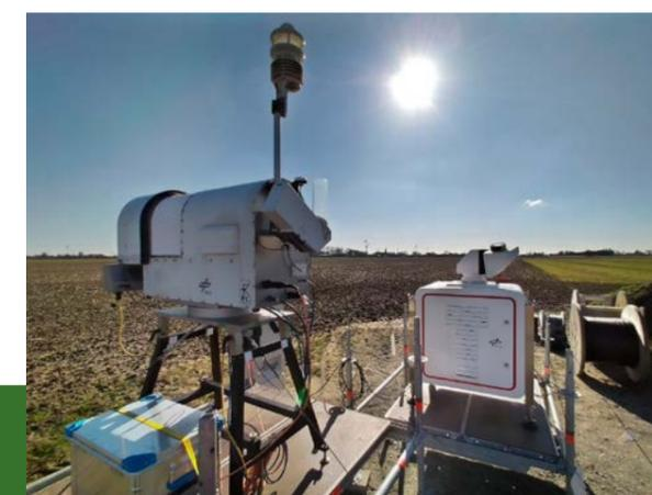
Das Lidar am Boden erfasst den Wind in bis zu 2.000 Meter Höhe. Das Mikrowellenradiometer misst Temperatur und Luftfeuchte bis in 10 Kilometer Höhe.
