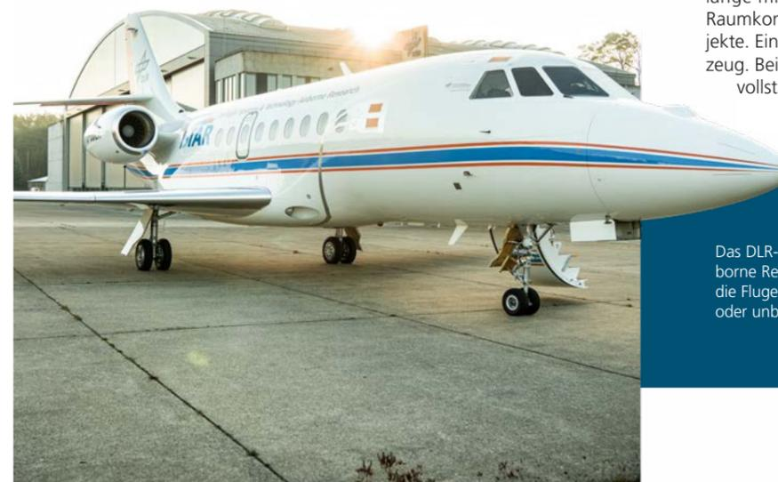
Das DLR-Forschungsflugzeug ISTAR (In-Flight Systems and Technologies Airborne Research) ist ein fliegender Simulator. Voll ausgebaut ist er in der Lage, die Flugeigenschaften neuer Flugzeugentwürfe real oder virtuell, bemannt oder unbemannt, unter realen Betriebsbedingungen zu testen.
