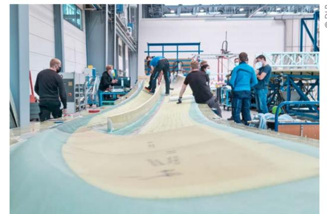
Im DLR-Zentrum für Leichtbauproduktionstechnologie in Stade testet das DLR-Team die Installation der Sensoren an den Rotorblättern.
