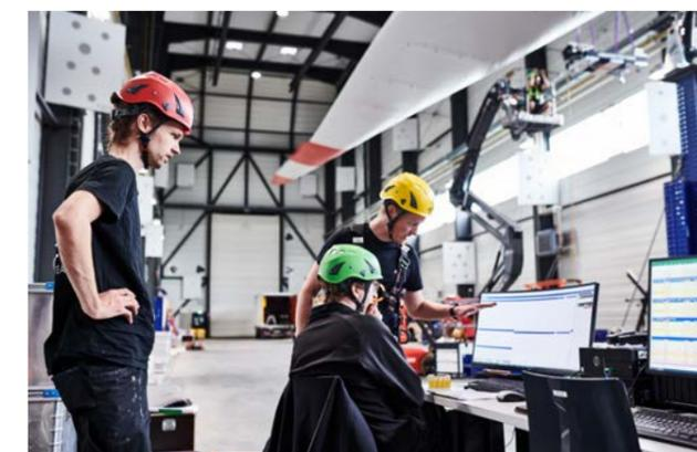
Vor der Montage wurden alle sechs Rotorblätter von den Fachleuten des DLR-Instituts für Aeroelastik dynamisch vermessen. Außerdem wurde ein Blatt in Zusammenarbeit mit Fraunhofer IWES statisch getestet.
