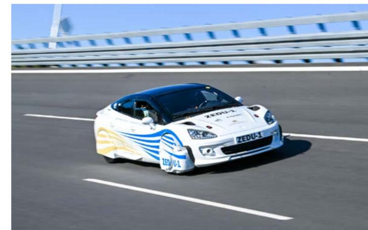
Mit dem Prototyp ZEDU-1 (Zero Emission Drive Unit – Generation 1) haben das DLR und das Automobilunternehmen HWA ein Elektroauto entwickelt, das auch den Ausstoß von Feinstaub und Mikroplastik weitestgehend reduziert.
