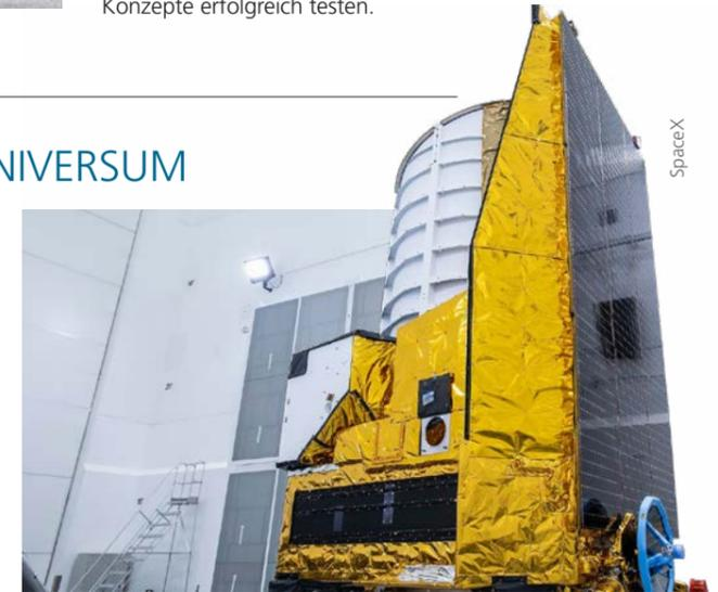
Das Teleskop wird am Adapter für eine Falcon-9-Rakete von SpaceX befestigt.
