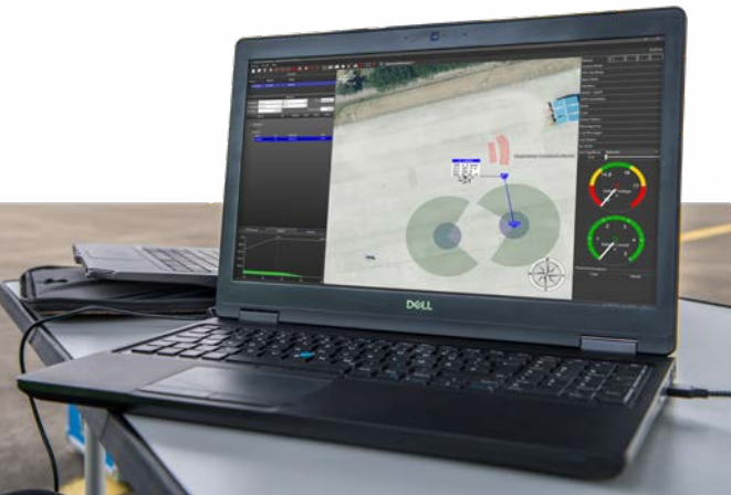
Ansicht der U-Fly-Software, einer Entwicklung des DLR-Instituts für Flugführung. Sie dient zur Kontrolle und Überwachung unbemannter Fluggeräte (kleinere UAV oder Lufttaxis). Hier können Routen geplant, Flüge freigegeben oder umgelenkt werden.
