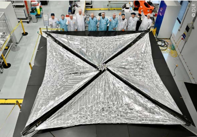
Das entfaltete Adeo-L-Segel im Labor des DLR-Instituts für Raumfahrtssysteme in Bremen
