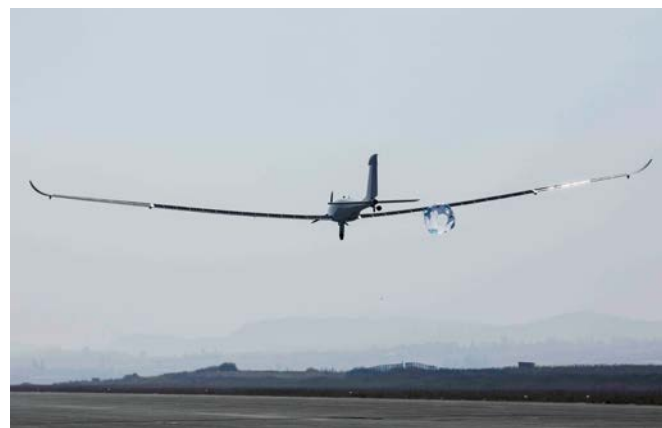
Unbemannte Version von Elektra Two beim Landen. Für ein stärkeres Abbremsen aktiviert das Autopilotensystem einen Fallschirm – ebenfalls eine Entwicklung von Elektra Solar.
