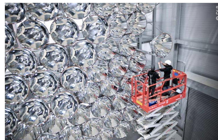
Die Strahler der Synlight-Anlage können eine bis zu 10.000-fache Konzentration des natürlichen Sonnenlichts erzeugen.
