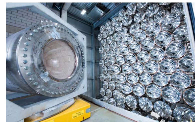
Reaktor zur thermischen Wasserstoffherzeugung
