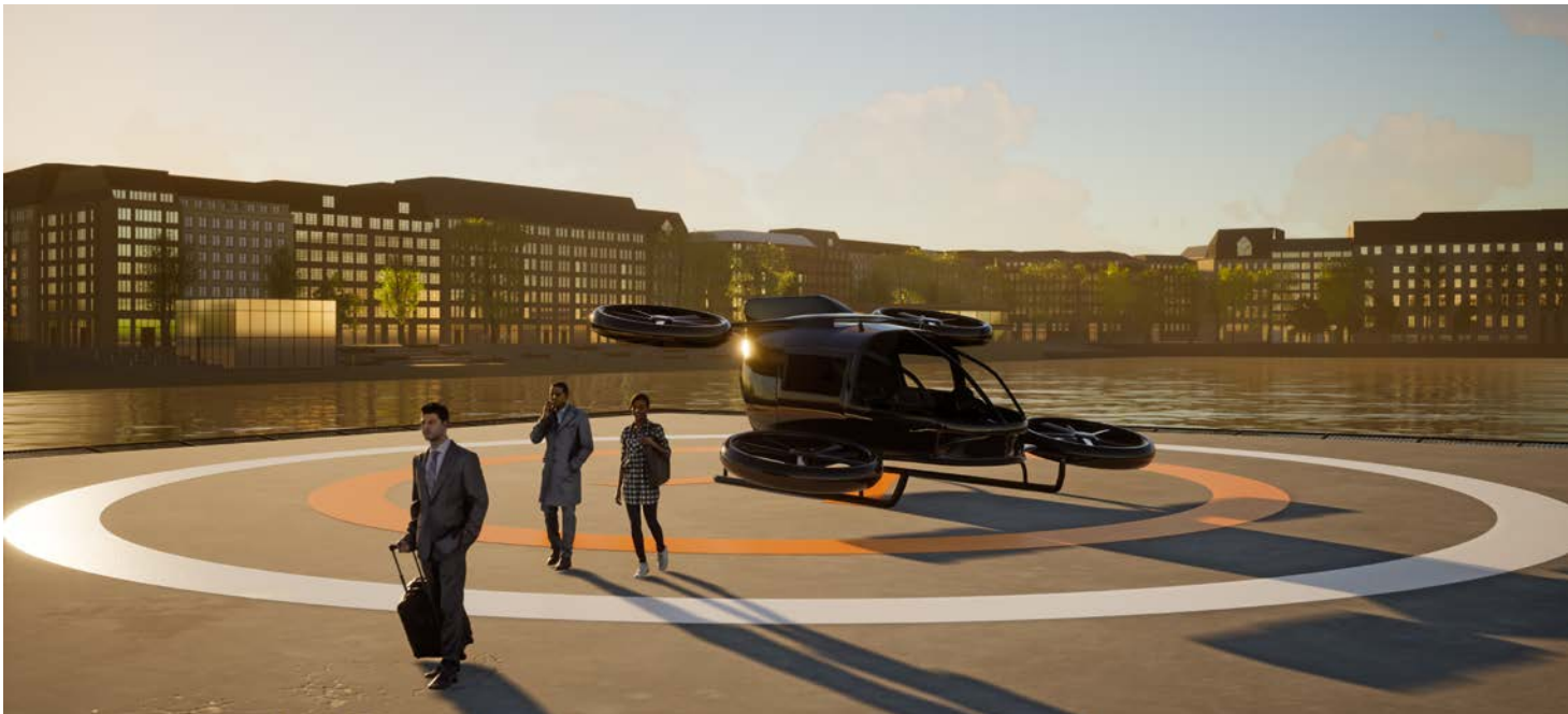
Wenn Flugtaxis autonom unterwegs sein sollen, müssen sie während des Landevorganges Personen auf dem Landepad selbstständig erkennen und das Kontrollzentrum warnen. Dann kann die Landung verzögert werden, bis der Landeplatz frei ist.
