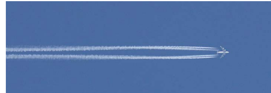
Rußpartikel aus Flugzeugtriebwerken wirken als Keime für Kondensstreifen.
