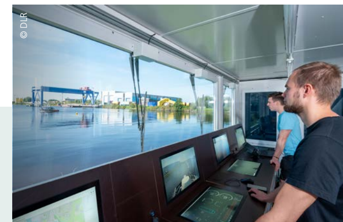
Die Technik an Bord von Sally kann Hindernisse eigenständig erkennen und auf einem Monitor anzeigen. Aus dem zur Schiffsbrücke umgebauten eMir-Container steuerten die Forscher das Boot aus der Ferne.
