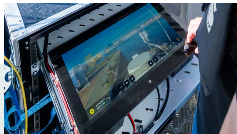
Die Technik an Bord von Sally kann Hindernisse eigenständig erkennen und auf einem Monitor anzeigen. Aus dem zur Schiffsbrücke umgebauten eMir-Container steuerten die Forscher das Boot aus der Ferne.
