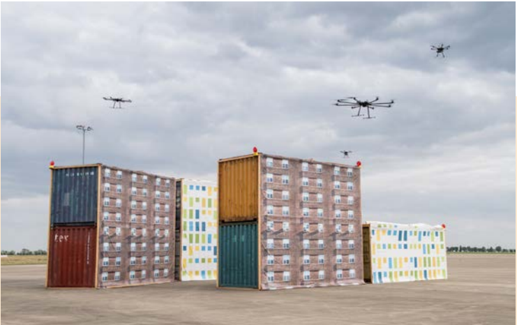
Kleine Multikopter repräsentierten Lufttaxis, Schiffscontainer simulierten die Häuserschluchten Hamburgs im Maßstab eins zu vier.
