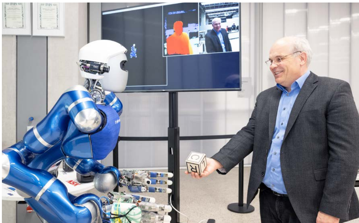
Prof. Berthold Bäuml reicht Justin einen Würfel. Auf dem Monitor im Hintergrund wird angezeigt, was Justin gerade „sieht“. Rot bedeutet, dass sich eine Person oder ein Gegenstand in der Nähe befinden, in größerer Entfernung erscheinen sie grün oder blau. Berthold Bäuml ist für Justins Weiterentwicklung verantwortlich und leitet unter anderem das Autonomous Learning Robots Lab.
