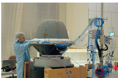
Виброиспытания носовой части.
