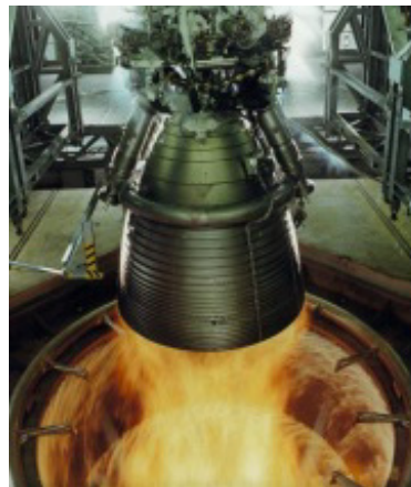
Triebwerk Vulcain 2 auf dem Prüfstand beim DLR in Lampoldshausen
