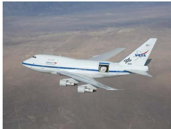
SOFIA bei einem Testflug mit offener Teleskoptür über der Mojave-Wüste in Kalifornien. Bild: NASA-AFRC.
