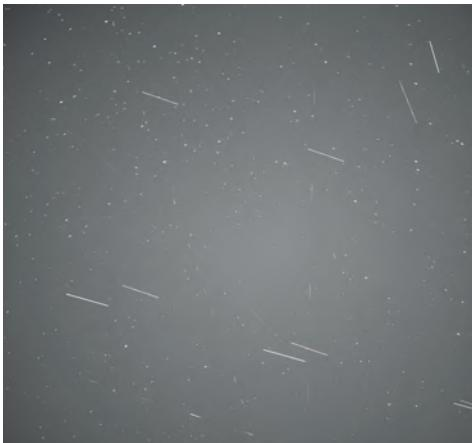
Für diese Aufnahme von APPARILLO, aufgenommen am DLR Standort Stuttgart, wurden 89 Einzelbilder mit je einer Sekunde Belichtungszeit überlagert. Die Strichspuren werden durch durchfliegende orbitale Objekte erzeugt. Die Sterne im Hintergrund dienen als Referenz für eine genaue Positionsbestimmung mittels Astrometrie.
