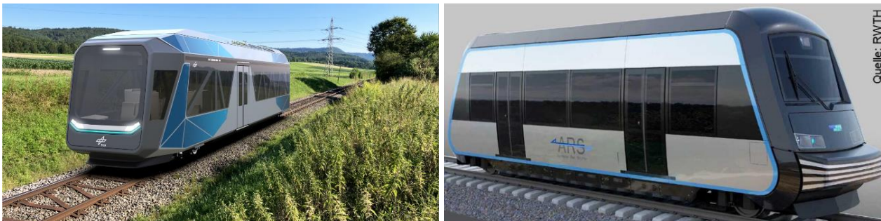
Kleinere, wirtschaftlichere und hoch automatisierte Schienenfahrzeuge für den Einsatz auf Strecken im ländlichen Raum, hier: beispielhaft das NGT-Taxi (links, Quelle DLR) und das Aachener Rail Shuttle (rechts, Quelle RWTH)
