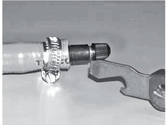
Stülpt die Schlauchklemme über das gleiche Ende und zieht sie mit einem Schraubenzieher so fest, dass es auch unter Druck nicht stabil bleibt.
