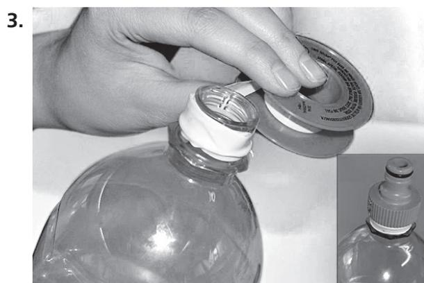
Nachdem der Flaschenhals abgekühlt ist, entfernt den Gardena-Wasserhahn-Anschluss und umwickelt zur Abdichtung den Flaschenhals mit Teflon-Band. Schraubt den Gardena-Wasserhahn-Anschluß auf.
