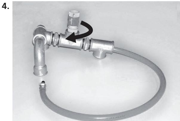
Schraubt die Gardena-Kupplung an der Seite des Schlauches fest, die aus dem mittleren T-Rohr herauschaut.
