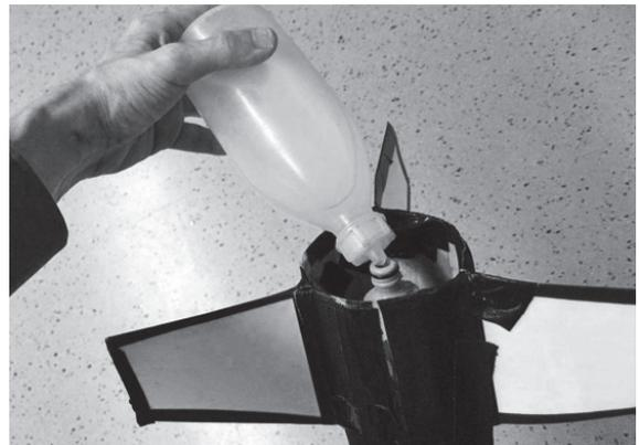
Befüllt den Tank über den Wasserhahn-Anschluss mit Wasser.
