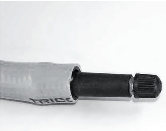
Verbindet das Autoventil mit dem Schlauch, indem ihr es an einer Seite hineinsteckt.
