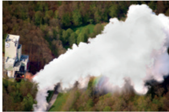
Luftbildaufnahme des Prüfstands P5 während eines Vulcain®2-Triebwerktests
