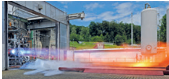
Versuche mit der Treibstoffkombination Flüssigwasserstoff und Methan am Prüfstand P3
