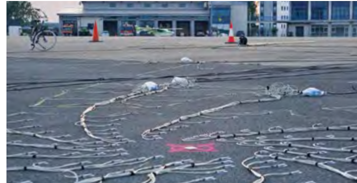
Überflugmessungen am Nationalen Erprobungszentrum für Unbemannte Luftfahrtsysteme: Mikrofonarrays messen den Schallpegel und einzelne Lärmquellen.
