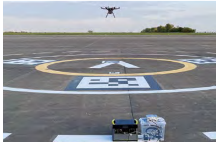
Flugversuche im Rahmen des Projektes HorizonUAM am Nationalen Erprobungszentrum für Unbemannte Luftfahrtsysteme – hier ein Haltepunkt für den städtischen Raum, ein sogenannter Vertiport
