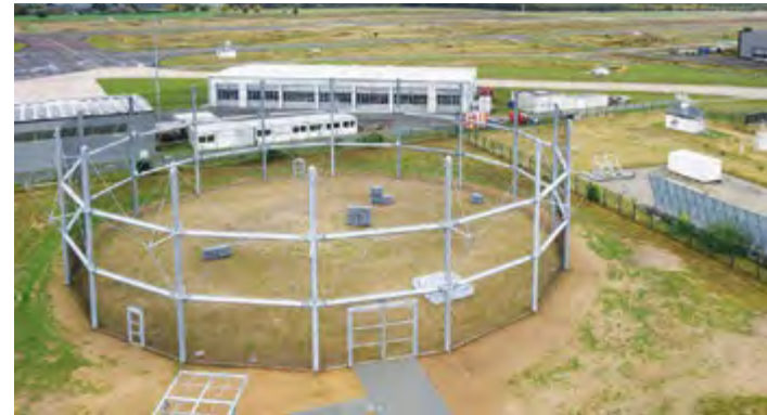
Der 2025 eröffnete Drohnenkäfig am Standort Braunschweig hat eine Grundfläche von 1.500 Quadratmetern und bietet auch Platz für Aufbauten wie Hindernisse oder Landeplätze. Hier werden Flugversuche höherer technologischer Reifegrade in einer realistischen Testumgebung durchgeführt.
