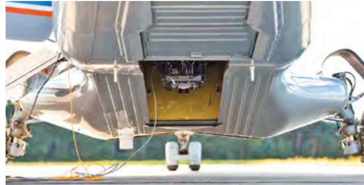
DO228-101 (D-CODE) mit instrumentiertem Schacht – Fernführung über Datenlink und digitalen Autopiloten zur Übertragung von Bilddaten an ein Lagezentrum
