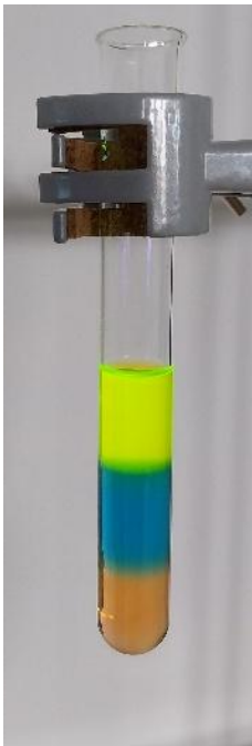
Pipettierübung für den Umgang mit Pipetten. Hier wurden jeweils zwei ml von Flüssigkeiten unterschiedlicher Dichte und Farbe (Zucker 40% in Wasser mit roter Lebensmittelfarbe, Wasser mit blauer Lebensmittelfarbe und Ethanol mit Fluorescein) übereinander geschichtet. Bildquelle: HSZG
