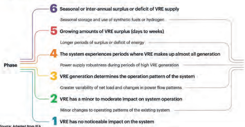
Abb. 1 Je weiter die erneuerbaren Energien ausgebaut werden, desto größer ist der Einfluss auf das Stromnetz. In Phase 1 ist der Anteil an regenerativ erzeugtem Strom so gering, dass der Einfluss zu vernachlässigen ist. Deutschland befindet sich bei der Integration der erneuerbaren Energien derzeit im Übergang von Phase 4 zu Phase 5
