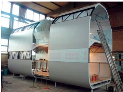
Normraum im Zusammenbau Standard coach interior being assembled
