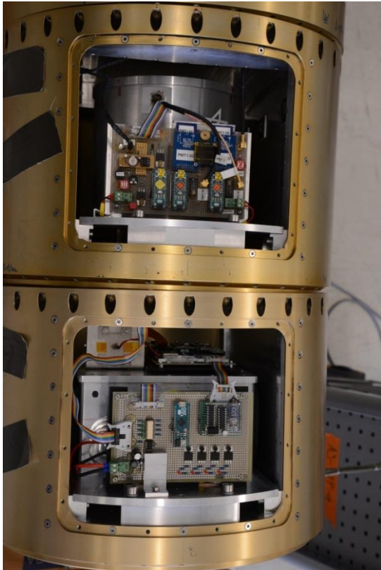
Abbildung 8: Biologische Nutzlasten auf Mapheus 8; Oben: MemEx – Experimenteinschub mit Hefeproben und Strahlungsdetektor M-42; Unten: CellFix mit ROPUM und apex
