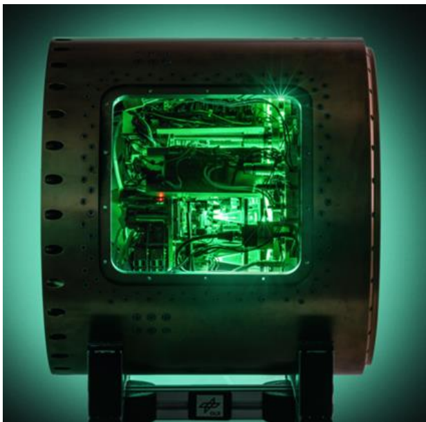
Abbildung 2: RAMSES – Experimentmodul mit eingeschalteten Treiblichtquellen
