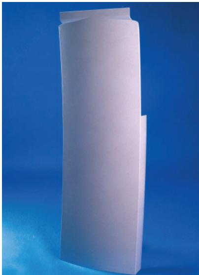
Innenverkleidung aus Bioverbundwerkstoff
