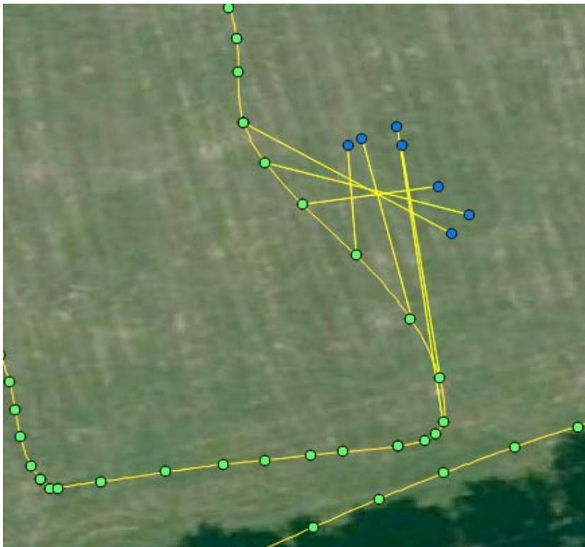
Abbildung 11: Fehler bei der direkten Georeferenzierung. Die Fundstelle eines Kitzes (blaue Punkte) kann ohne Kalibrierung nicht präzise ermittelt werden.
