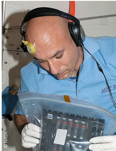
Forscher interessieren sich für den Biorhythmus der Astronauten. Die Körperkerntemperatur ist ein guter Indikator, wenn sich dieser circadiane Rhythmus verschiebt – die innere Uhr anders tickt. Der italienische Astronaut Luca Parmitano trägt auf der Stirn einen nicht-invasiven Thermosensor, der seine Körperkerntemperatur aufzeichnet. Alexander Gerst wird diese Forschung nun fortsetzen.
