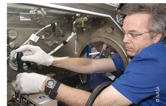
Der kanadische Astronaut Robert Thirsk installiert die SODI-Apparatur in der Microgravity Science Glovebox (MSG) im Columbus-Modul. Alexander Gerst soll in dieser Anlage das Verhalten von Fluiden in Schwerelosigkeit untersuchen.
