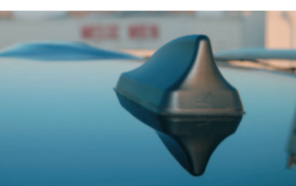
Prototyp einer Haihaifischflossen-Antenne für Satellitenkommunikation in Fahrzeugen
