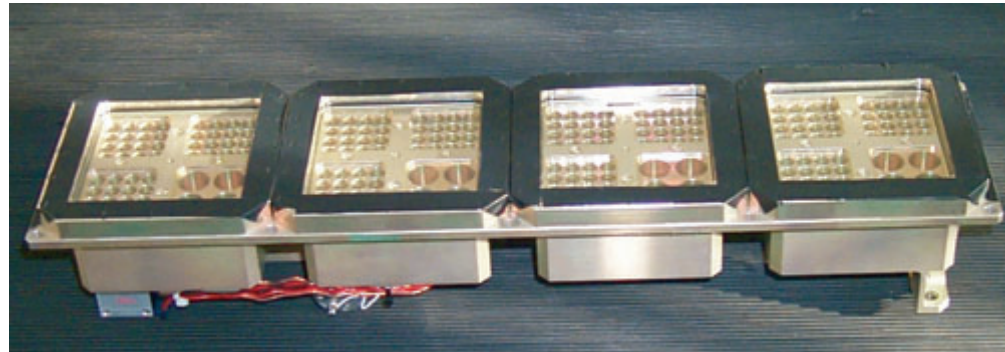
Expose-EuTEF: Behälter für die Proben Expose-EuTEF: Sample Containers
