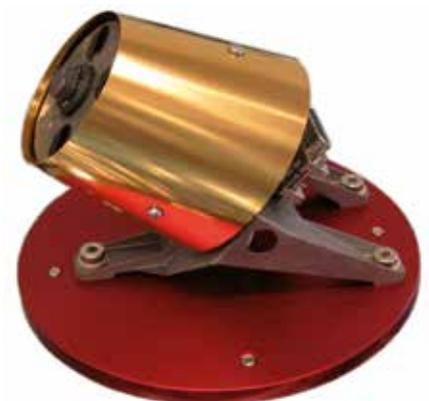
Bestandteil des HP<sup>3</sup>-Experiments ist das Radiometer RAD. Es misst vom Instrumentendeck die Strahlung der Oberfläche, die in etwa der Oberflächentemperatur entspricht.
