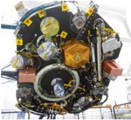
Auf der *InSight*-Plattform sind die Experimente, Subsysteme und Systemkomponenten angebracht: In der Bildmitte SEIS, rechts davon der Roboterarm und links von dessen unterem Ende HP<sup>3</sup>.
