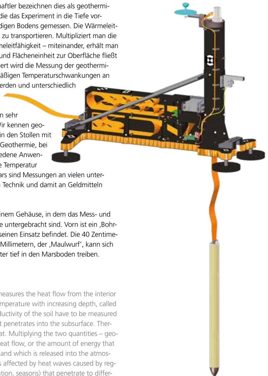
Die ‚Sphinx‘ und der ‚Maulwurf‘ sind durch ein Flachband-Messkabel miteinander verbunden, das aus der unteren Kammer des HP<sup>3</sup>-Instruments hinter dem Hammerschlagmechanismus hergezogen wird. In der oberen Kammer befindet sich das Datenkabel, das mit der *InSight*-Plattform verbunden ist.
