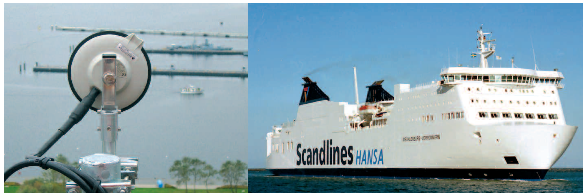
Einer der im Hafen von Rostock installierten Galileo-Signalgeneratoren
