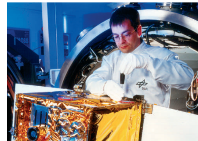
Der vom DLR entwickelte Satellitenbus BIRD im Labor
