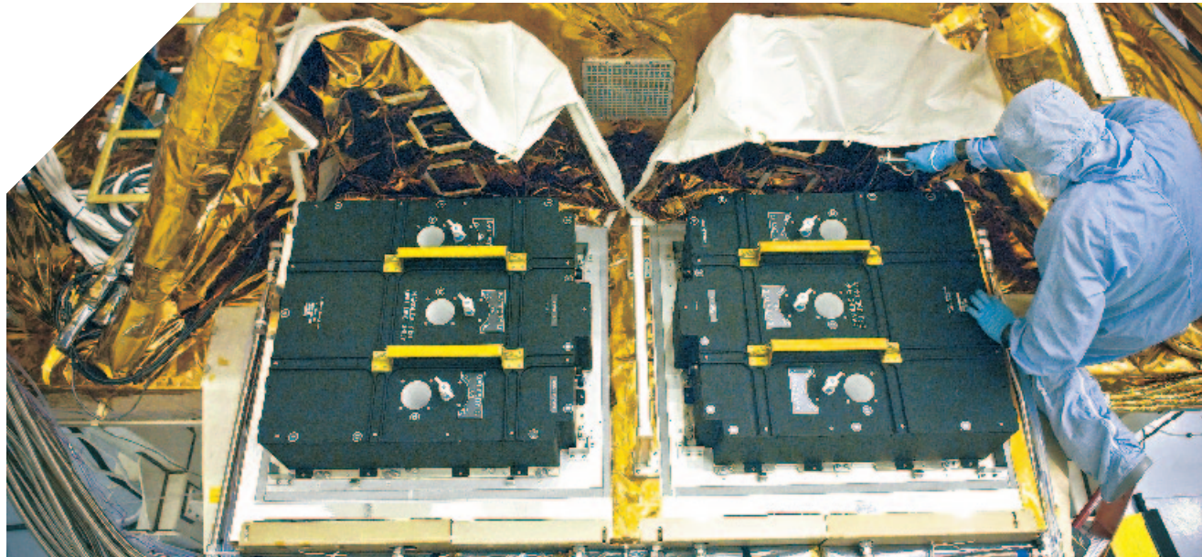
Das neue Batterien-Set für Hubble bei Vorbereitungs-Arbeiten im Reinraum (NASA)
