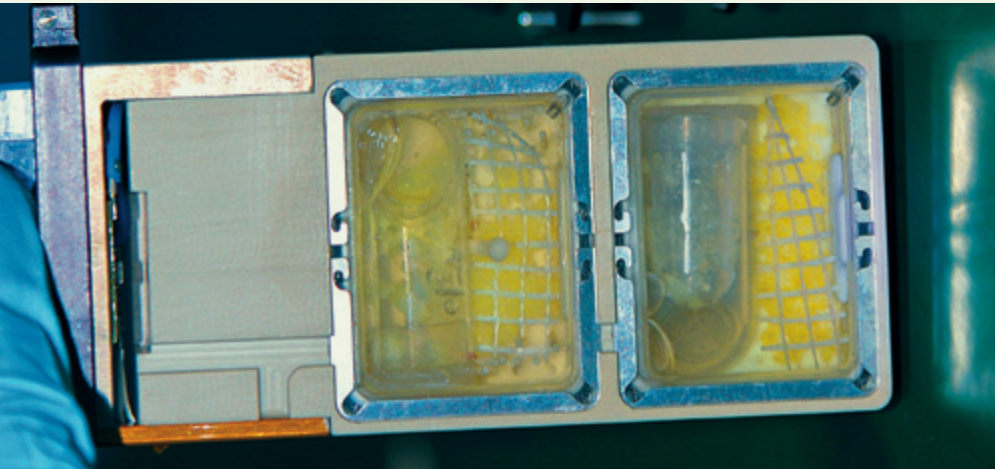
In dieser SIMBOX-Apparatur wurden Reis- und Arabidopsis-Zellen auf Veränderungen durch die Schwerkraft untersucht.
