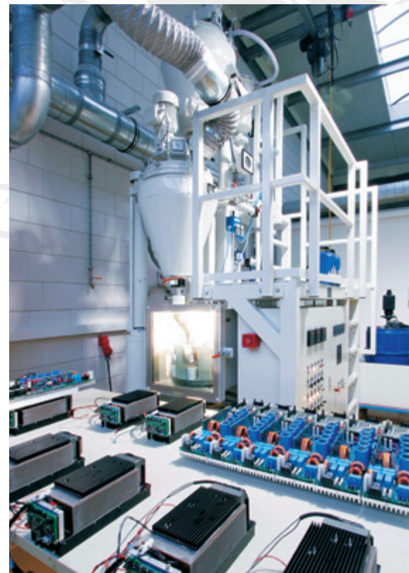
Die Firma ASP hat sich auf die Entwicklung und die Herstellung von Leistungselektronik spezialisiert. In der Vergussanlage (l.) werden Baugruppen unter Vakuum mit einem ESA-zertifizierten Spezialharz für ihre Aufgabe als Hochspannungsversorgung bis 30 Kilovolt vergossen. Im Mikroschlifflabor (r.) werden die Ergebnisse der eigenen Produktionsprozesse detailliert sichtbar gemacht, um die Einhaltung der hohen Qualitätsstandards dauerhaft zu sichern.
