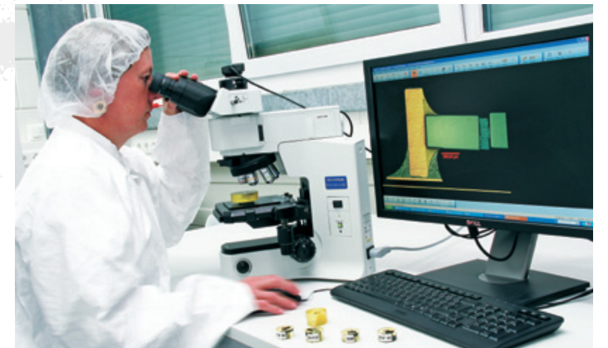
Die Firma ASP hat sich auf die Entwicklung und die Herstellung von Leistungselektronik spezialisiert. In der Vergussanlage (l.) werden Baugruppen unter Vakuum mit einem ESA-zertifizierten Spezialharz für ihre Aufgabe als Hochspannungsversorgung bis 30 Kilovolt vergossen. Im Mikroschlifflabor (r.) werden die Ergebnisse der eigenen Produktionsprozesse detailliert sichtbar gemacht, um die Einhaltung der hohen Qualitätsstandards dauerhaft zu sichern.
