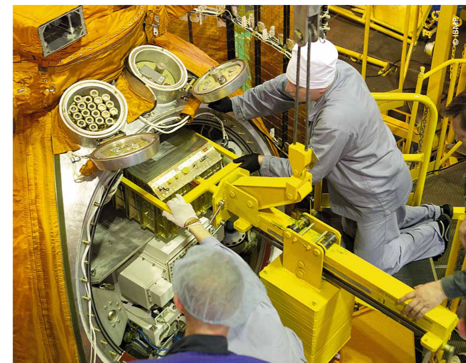
Sobald das Hornkraut eingepflanzt ist, ziehen die Fische, Schnecken und die Algen in die Mini-WG ein. Danach wird das OmegaHab in den Experimentcontainer eingesetzt. Zum Schluss wird mit Algenlösung aufgefüllt. Ist der Experimentcontainer geschlossen, wird er in die BION-M1-Kapsel eingebaut.
