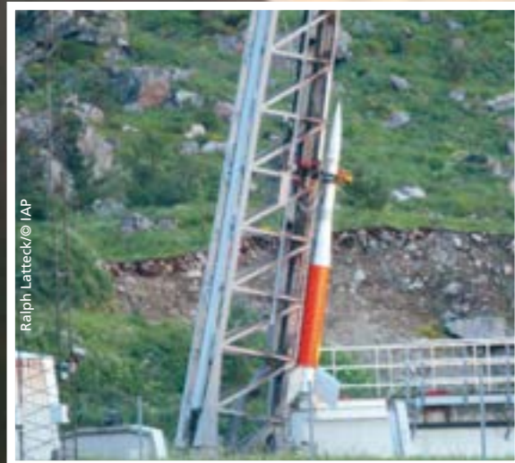
Die Rakete steht im Startturm und ist für ihren zehnminütigen Flug in Richtung Mittlere Atmosphäre bereit.
